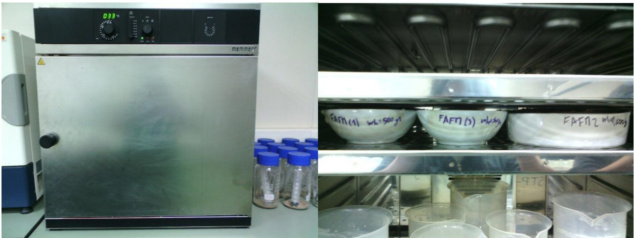
Figura B.3: Implementos utilizados en proceso de secado de muestras. A la izquierda se observa el horno marca Memmert utilizado, a una temperatura aproximada de 33°C. A la derecha se observan las muestras cuarteadas en cantidades de 500 gr y 700 g. Las muestras han sido etiquetadas previamente, registrando el código de la muestra, peso del recipiente y peso de la muestra húmeda.
