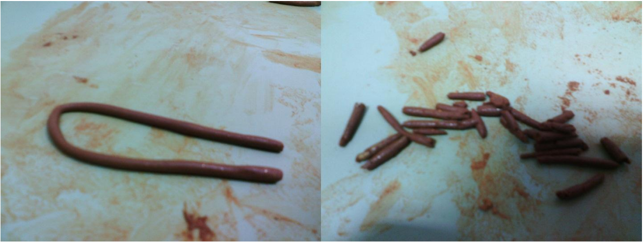
Figura B.5: Procedimiento para cálculo de límite plástico. La disgregación de los bastoncillos debe ser en trozos de 5 a 10 mm para poder proceder a secado de muestras.
