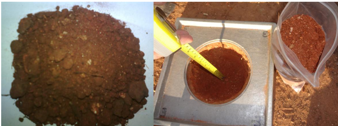
Figura 4.3: Suelo residual afectado por incendio. Se caracteriza por sus colores rojizos o anaranjados, su baja humedad en terreno y su dureza al excavar.
