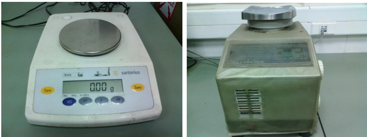
Figura B.2: Balanzas utilizadas en el procedimiento. A la izquierda balanza con precisión 0,01 gr. A la derecha balanza con precisión 0,1 gr. Ambas balanzas son de marca Sartorius. Se utilizó una balanza de 0,1 gr de precisión para las pruebas posteriores, debido a que la tara de los pocillos no se puede realizar con la balanza más precisa (debido a su peso máximo de 400 gr).
