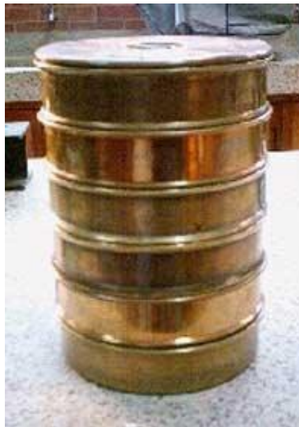
Figura B.4: Mallas utilizadas para tamizaje. Se requirió utilizar 8 mallas a la vez, con un tiempo de tamizaje de 15 minutos por muestra.
