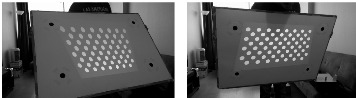
Figura 3.6: Proceso de calibración del proyector, proyectando un patrón conocido sobre un tablero con marcadores.
