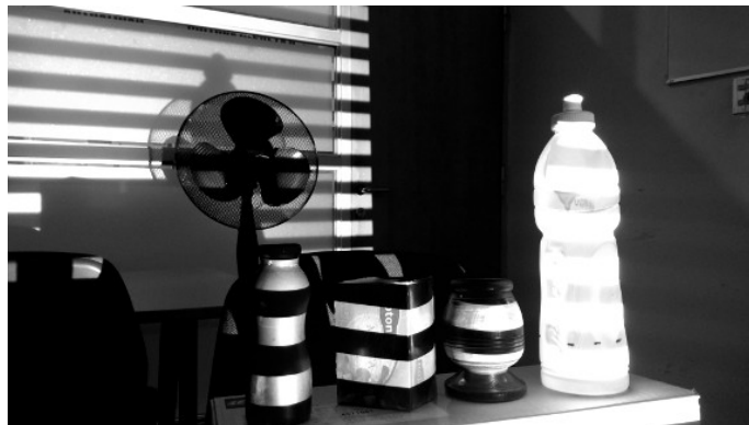
Figura 3.17: Problemas en la captura del patrón proyectado cuando la escena a digitalizar tiene variaciones muy altas en su reflectancia.
