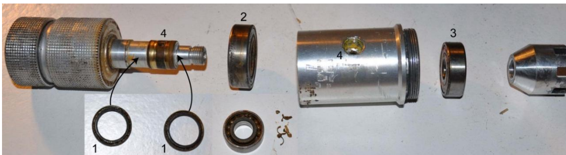
Figura A2.4: Interior del adaptador de la perforadora. 1: Orrines; 2 y 3: Rodamientos (2a: detalle del rodamiento agripado); 4 y 5: sistema de lubricación, en 4 va la llave hacia la manguera, en 5 se observa un orificio por donde sale el agua hacia el interior de la broca. El agua pasaba hacia los rodamientos debido a la corrosión de los orrines. Una vez el agua llegó a los rodamientos era cosa de tiempo para que estos se agriparan, especialmente si era agua salada, como en nuestro caso.
