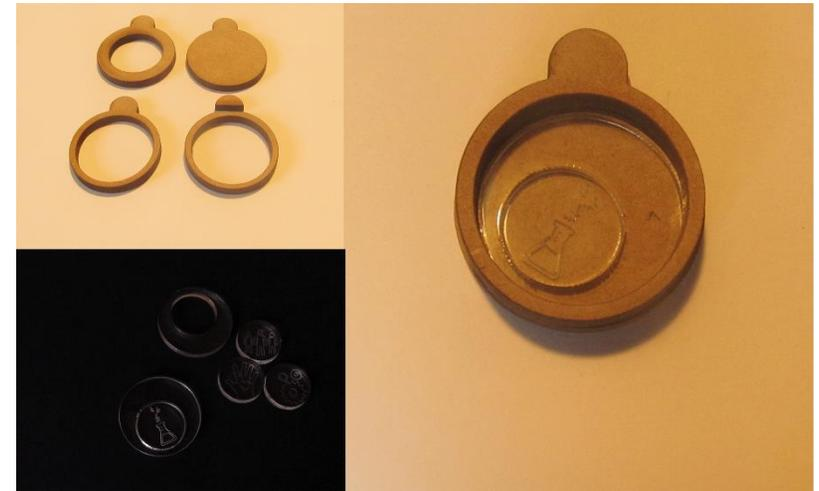
Fotografía 12: Piezas hechas por corte láser en MDF y acrílico. (Elaboración Propia)
