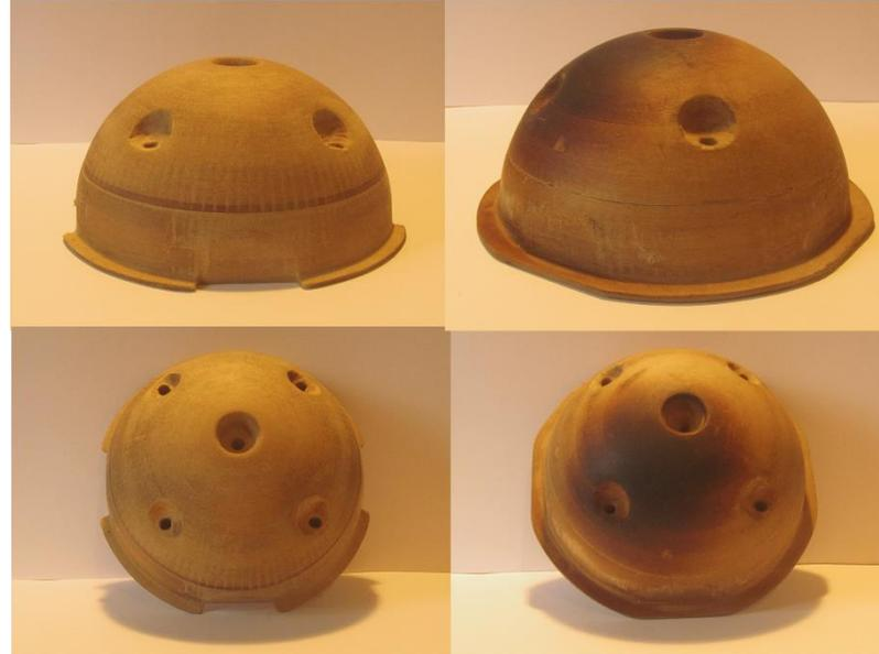
Fotografía 5: Moldes esfera central. A la izquierda uno con menor nivel de acabado y a la izquierda uno con mayor nivel de acabado, (Elaboración propia).
