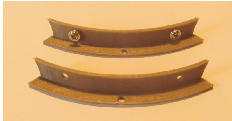
Fotografía 16: Fijaciones laterales para la esfera central. (Elaboración propia).
