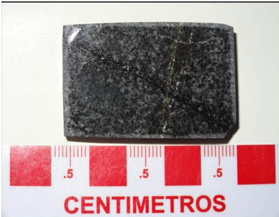
AA1438: Aspecto general de la muestra en rechazo. Se aprecian cristales de plagioclasa, piroxeno y hornblenda. Magnetismo intenso en la muestra.
