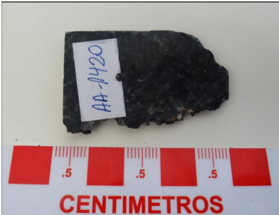
AA1420: Aspecto general de la muestra en rechazo. Se aprecian cristales de plagioclasa, piroxenos y anfíboles. El rechazo presenta magnetismo.
