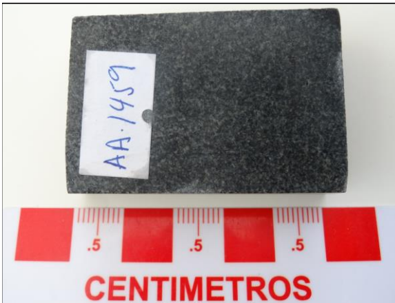
AA1439: Aspecto general de la muestra en rechazo. Roca de textura afanítica perteneciente a un dique. Se observan microcristales de plagioclasa y hornblenda.
