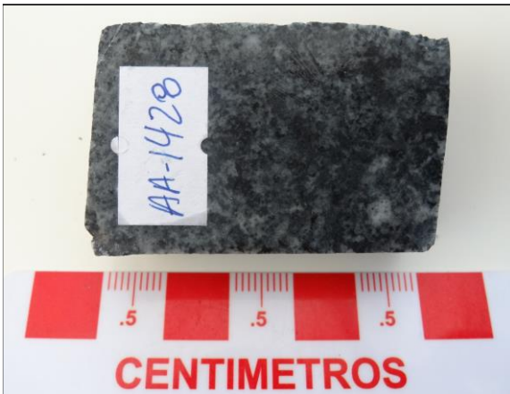
AA1428: Aspecto general de la muestra en rechazo. Se aprecian cristales de plagioclasa, piroxeno y anfíboles.
