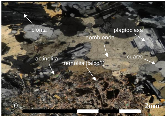
Muestra AA1406: Microfotografía a nicoles cruzados con aumento de 5x. Cristal de piroxeno alterado intensamente a tremolita (talco?), hornblenda, plagioclasa, cuarzo, actinolita y clorita (en vetilla).
