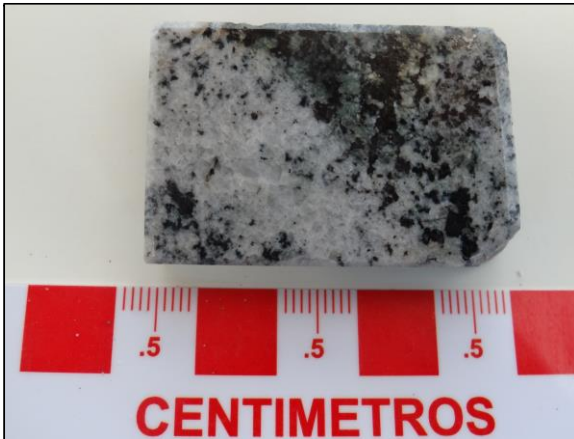
AA1433: Aspecto general de la muestra en rechazo. Se aprecian cristales de plagioclasa, anfíboles, cuarzo y biotita con menor clorita, epidota y actinolita como minerales de alteración. Magnetismo leve.
