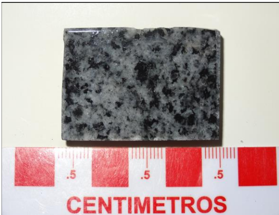
AA1418: Aspecto general de la muestra en rechazo. Se aprecian cristales de plagioclasa, piroxenos, hornblenda y biotita. Presenta Magnetismo.
