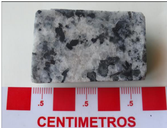
AA1419: Aspecto general de la muestra en rechazo. Roca de textura fanerítica. Se observan cristales de plagioclasa, anfíbol, biotita y cuarzo. Menor actinolita, epidota y clorita.
