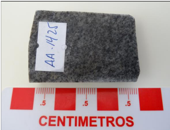
AA1425: Aspecto general de la muestra en rechazo. Se aprecian cristales de plagioclasa, cuarzo y biotita.
