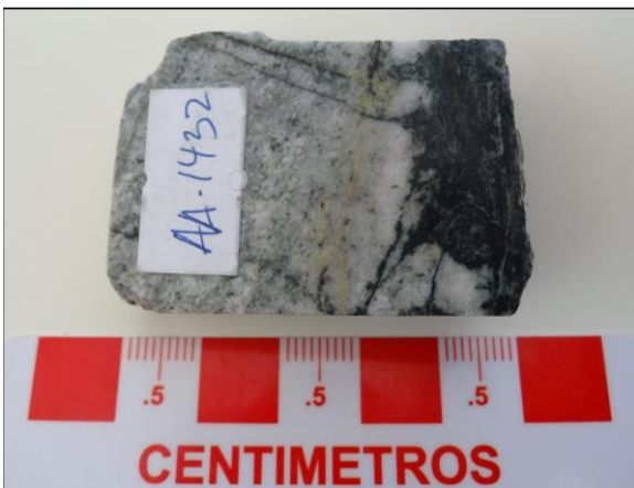
AA1432: Aspecto general de la muestra en rechazo. Se observan cristales de plagioclasa y cuarzo y pátina de alteración con minerales de actinolita, clorita y epidota.
