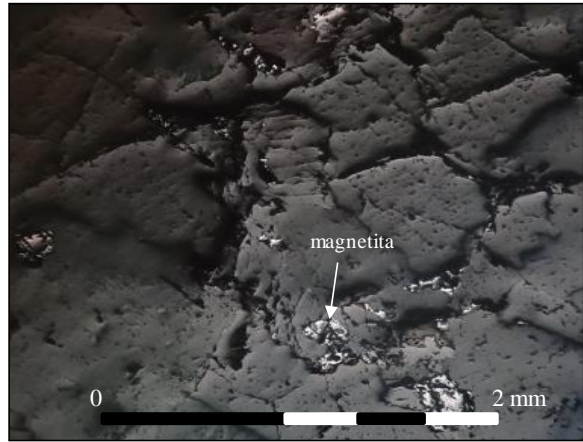
AA1414: Microfotografía a nicols paralelos con aumento de 5x. Mineralización de magnetita diseminada.
