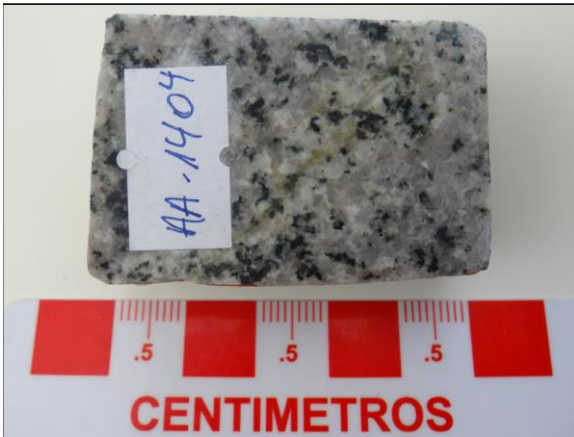
AA1404: Aspecto general de la muestra en rechazo. Se aprecian cristales de feldespato, anfíboles, cuarzo y microvetilla semirecta, discontinua sin halo, de bordes nítidos rellena con epidota.
