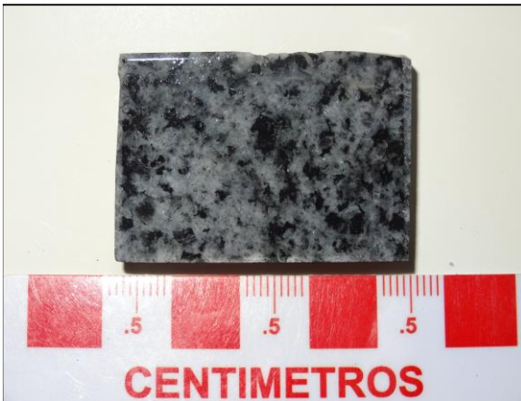
AA1418: Aspecto general de la muestra en rechazo. Se aprecian cristales de plagioclasa, piroxeno, hornblenda y biotita. El rechazo presenta magnetismo.
