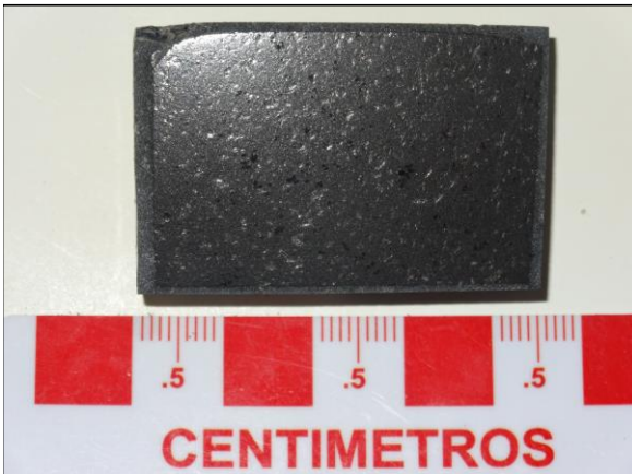
AA1426: Aspecto general de la muestra en rechazo. Roca de textura porfírica. Se observan fenocristales de plagioclasa y piroxeno.
