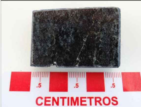
AA1430: Aspecto general de la muestra en rechazo. Se aprecian cristales de plagioclasa, anfíbol (hornblenda), piroxeno y cuarzo. Vetilla <0,1 mm rellena con actinolita. Presenta Magnetismo.
