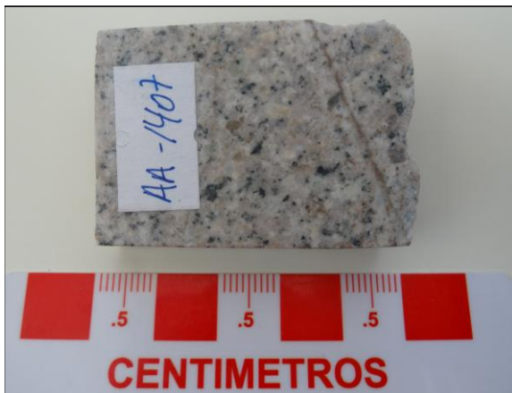
AA1407: Aspecto general de la muestra en rechazo. Roca de textura fanerítica perteneciente a un dique. Se aprecian cristales macroscópicos de plagioclasa, feldespato potásico, cuarzo y biotita.
