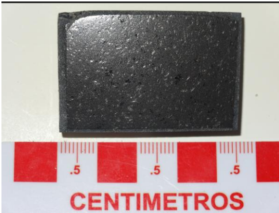
AA1426: Aspecto general de la muestra en rechazo. Se aprecian cristales de plagioclasa y piroxeno inmersos en una masa fundamental. También cúmulos de carbonatos.
