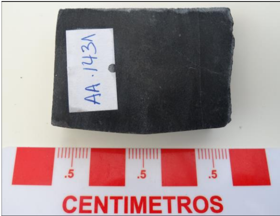
AA1431 Aspecto general de la muestra en rechazo. Se aprecian cristales de plagioclasa inmersos en una masa fundamental oscura. El rechazo presenta magnetismo intenso.
