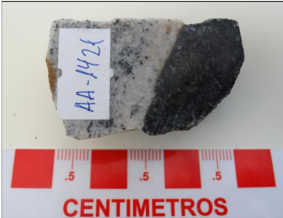
AA1421: Aspecto general de la muestra en rechazo. Se aprecian cristales de feldespato potásico, plagioclasa, cuarzo y biotita. El sector izquierdo del rechazo es el representativo del afloramiento.
