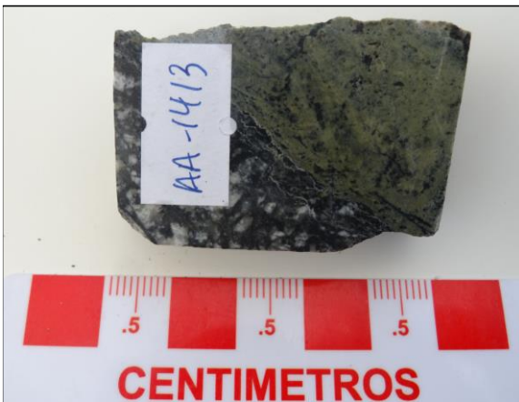
AA1413: Aspecto general de la muestra en rechazo. Se aprecian cristales de plagioclasa y cuarzo visibles y actinolita y epidota dispuestos masivamente en un sector de la muestra.
