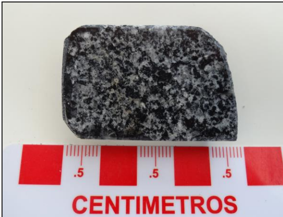
AA1410: Aspecto general de la muestra en rechazo. Se aprecian cristales plagioclasas y anf. bol. El rechazo presenta magnetismo.
