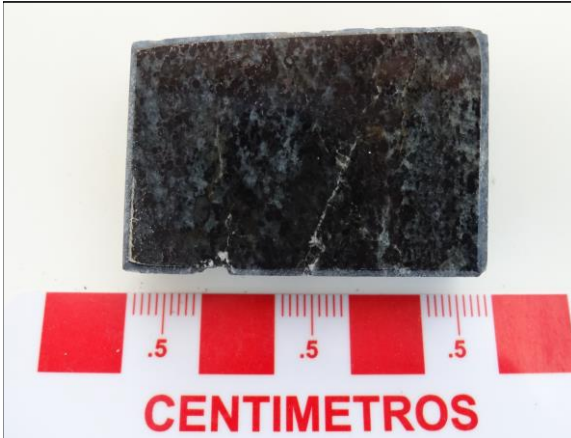
AA1430: Aspecto general de la muestra en rechazo. Se aprecian cristales de plagioclasa, anfíboles, piroxenos y cuarzo. Vetilla <0,1 mm rellena con actinolita. Presenta Magnetismo.
