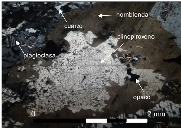
Muestra AA1440: Microfotografía a nicols cruzados con aumento de 5x. Cristal de piroxeno como inclusión en cristal de hornblenda. También se observan cristales de plagioclase, opácos y cuarzo.
