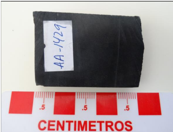
AA1429: Aspecto general de la muestra en rechazo. Roca de textura afanítica perteneciente a un dique.
