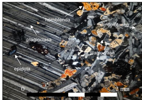
Muestra AA1440: Microfotografía a nicols cruzados con aumento de 5x. Contacto de veta de grano fino con cristal de plagioclase de grano grueso. Epidota selectiva en plagioclases.
