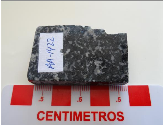
AA1422: Aspecto general de la muestra en rechazo. Se aprecian cristales plagioclasa, piroxeno, anfíbol, biotita y cuarzo. El rechazo presenta magnetismo leve.
