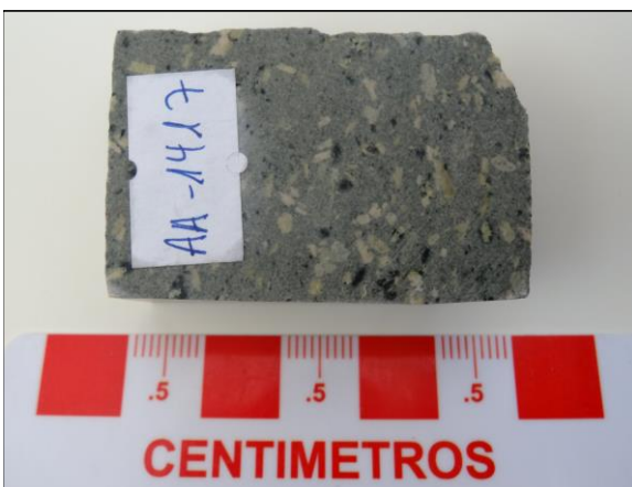
AA1417: Aspecto general de la muestra en rechazo. Roca de textura porfídica con fenocristales de plagioclasa epidotizadas y silicatos máficos con cloritización total.
