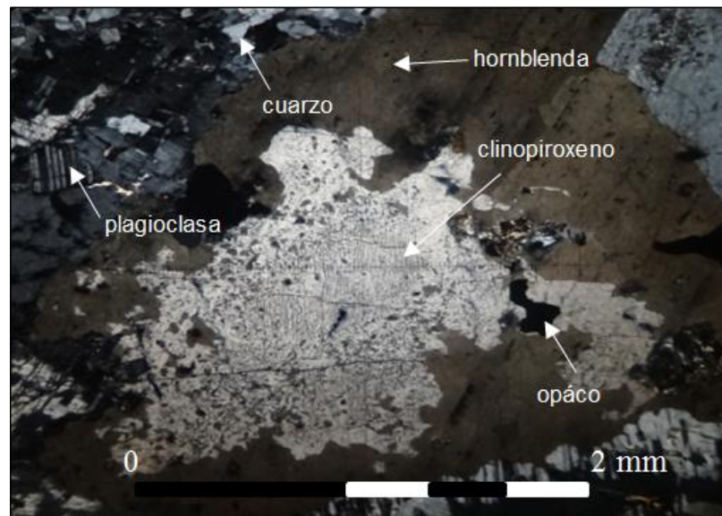
Figura 4-2: Microfotografía a nicols cruzados con aumento de 5x de la muestra AA1440 correspondiente a un gabro de piroxeno y hornblenda. Textura coronítica en cristal de clinopiroxeno rodeado totalmente por cristal de hornblenda. También cristales de plagioclasa, opácos y cuarzo.
