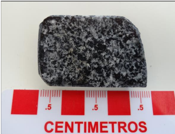
AA1410: Aspecto general de la muestra en rechazo. Se aprecian cristales de plagioclasa, anfíbol, cuarzo y vetilla semirecta, discontinua sin halo, de bordes nítidos rellena con epidota.
