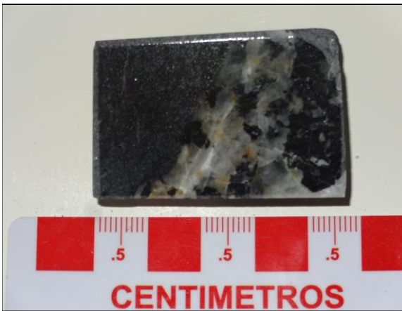
AA1440: Aspecto general de la muestra en rechazo. Se aprecian cristales de plagioclasa, piroxeno y hornblenda. También opacos.
