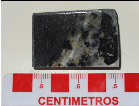
AA1440: Aspecto general de la muestra en rechazo. Se aprecian cristales de plagioclasa, piroxeno y hornblenda. También opácos. Magnetismo leve en rechazo.
