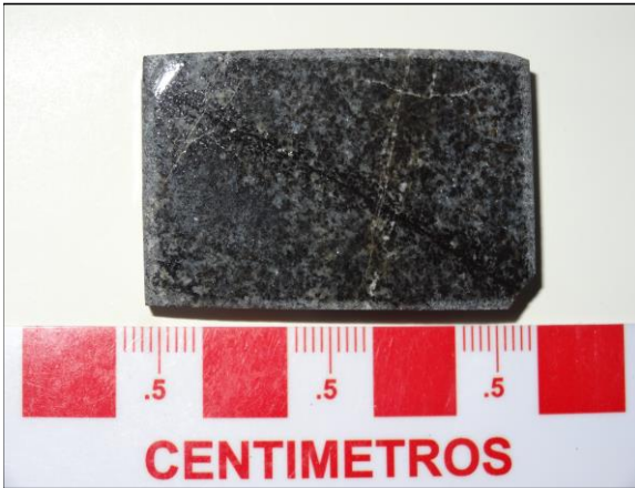
AA1438: Aspecto general de la muestra en rechazo. Se aprecian cristales de plagioclasa, piroxeno y hornblenda.
