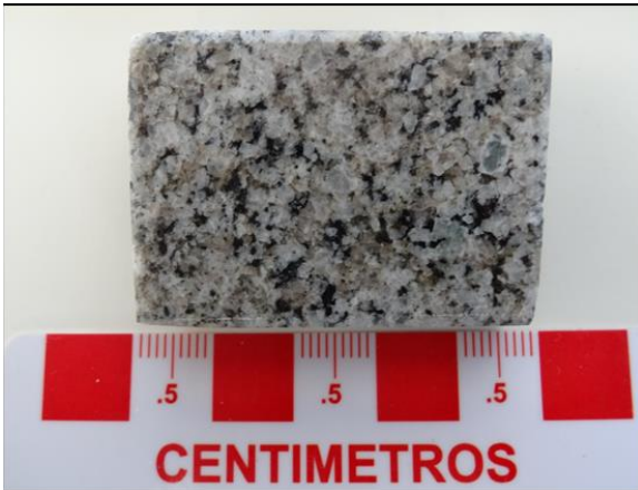
AA1435: Aspecto general de la muestra en rechazo. Se aprecian cristales de plagioclasa, hornblenda, biotita y cuarzo. El rechazo presenta magnetismo intenso.
