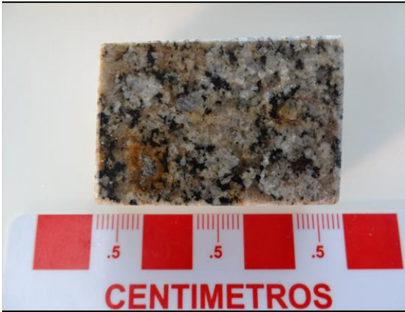
AA1414: Aspecto general de la muestra en rechazo. Se aprecian cristales de plagioclasa, feldespato potásico, anfíboles y cuarzo. Óxidos de Hierro visibles y presencia de magnetismo.
