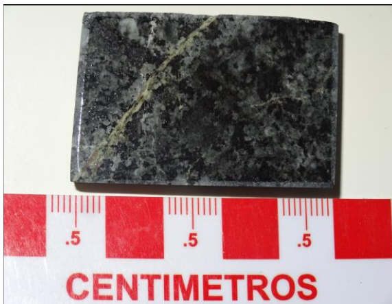
AA1403: Aspecto general de la muestra en rechazo. Se aprecian cristales de plagioclasa y anfíbol. Vetillas de espesores variables (~0,1-~2 mm) rellenas con epidota, cuarzo, actinolita, clorita y opácos.
