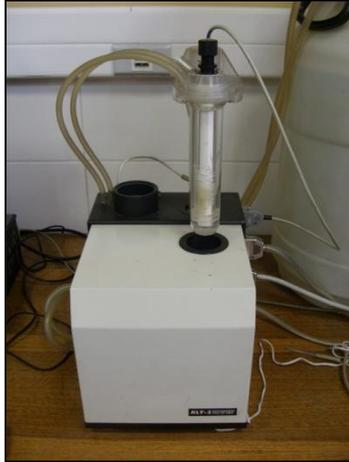
Figura 4. Kappabridge KLY-3S para análisis de temperatura de Curie.
