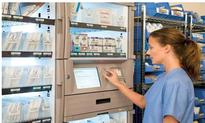
Figura N°15: ejemplo de sistema de dispensación automatizado, Pyxis®.
