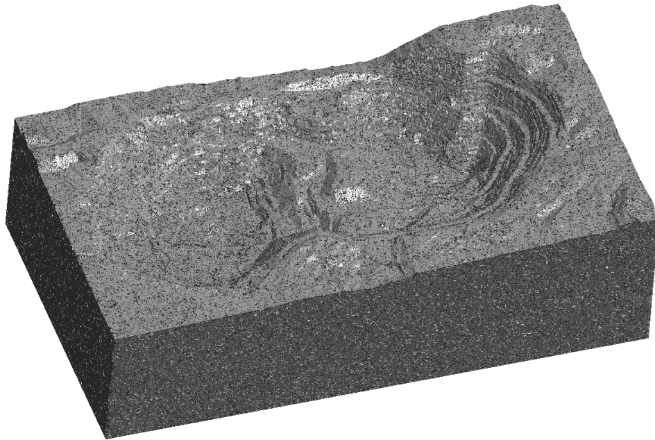
Figura 4.11: Malla creada por Opit 1.0 (Límite volumen por elemento = 1000 m 3 ).
