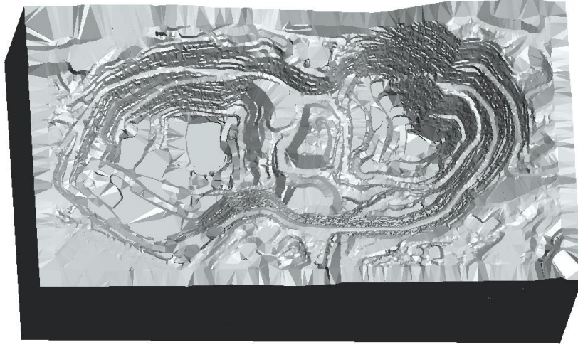
Figura 4.12: Malla creada por Opit 1.0. Aristas de elementos ocultas. Caras de elementos visibles.
