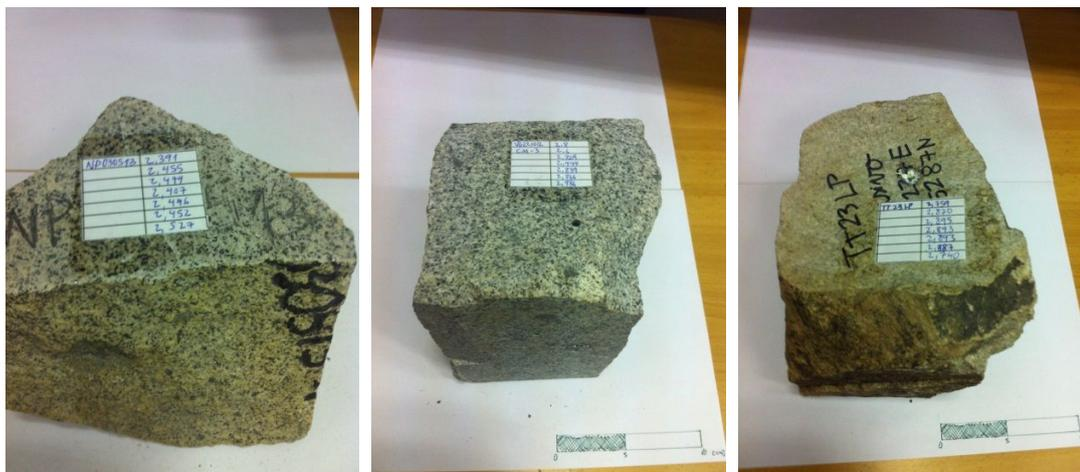
**Figura 21: Muestras de rocas intrusivas perforadas con la pasta conductora necesaria.**
