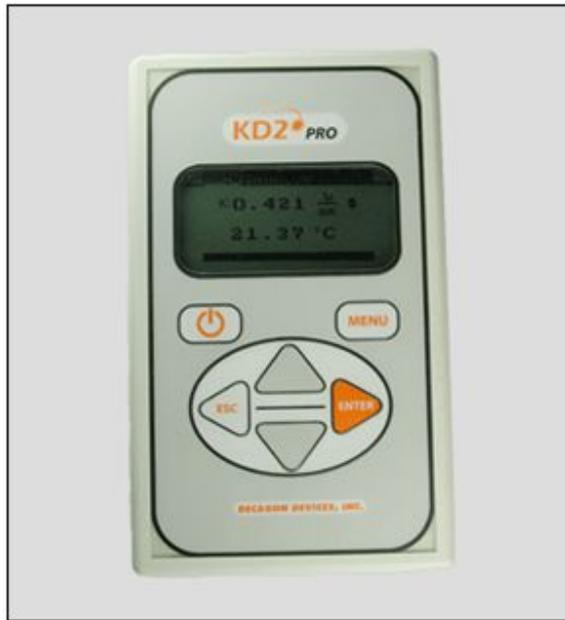
Figura 16: Dispositivo KD2 Pro, *Decagon Devices*, para mediciones de conductividad térmica.
