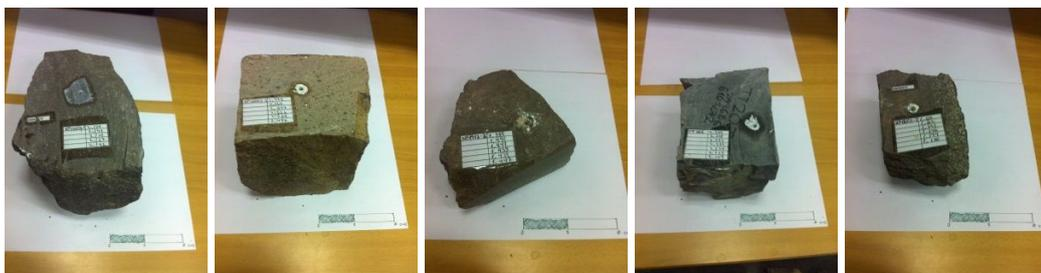
Figura 19: Muestras perforadas con pasta conductora introducida previo a la medición.
