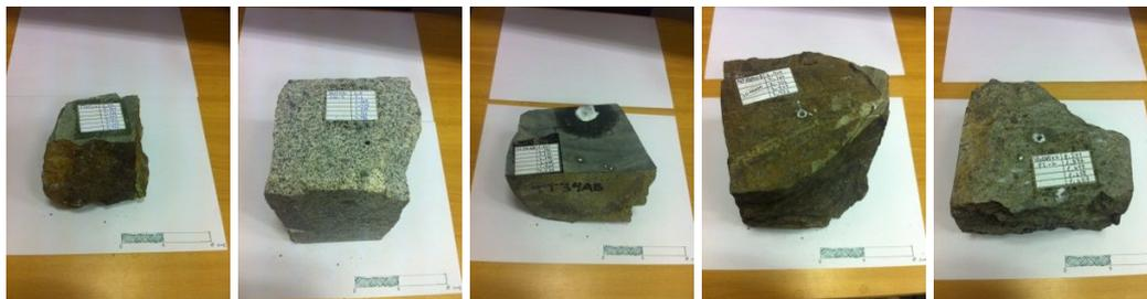
**Figura 20: Muestras perforadas con pasta conductora introducida previo a la medición .**
