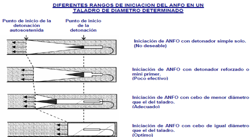
Ilustración 15: Rangos de iniciación del ANFO según ubicación y tamaño del cebo.
