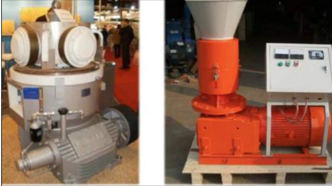
Ilustración 23: Prensas de pelletizado de residuos madereros. Prensa matriz plana (Izquierda); matriz anular (Derecha)
