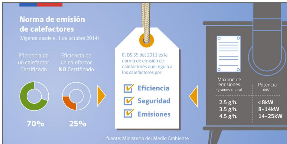
Ilustración 14: Norma de emisión de calefactores
