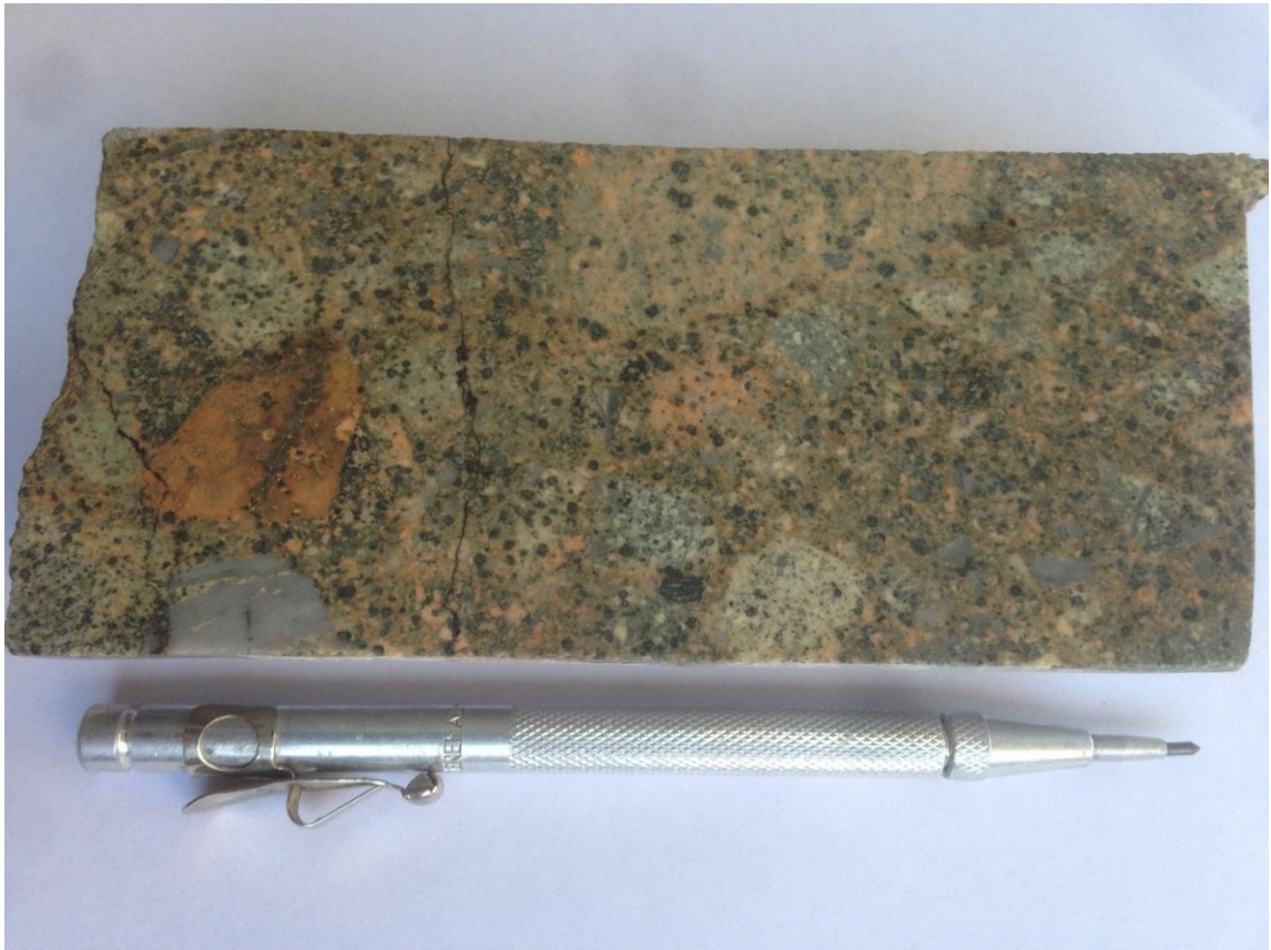
Figura 3.17. Brecha magmático-hidrotermal polimíctica con masa fundamental ígnea.
