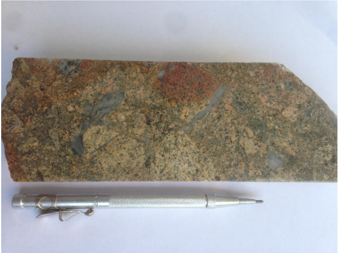
Figura 3.16. Brecha magmático-hidrotermal con masa fundamental de cuarzo y material ígneo.
