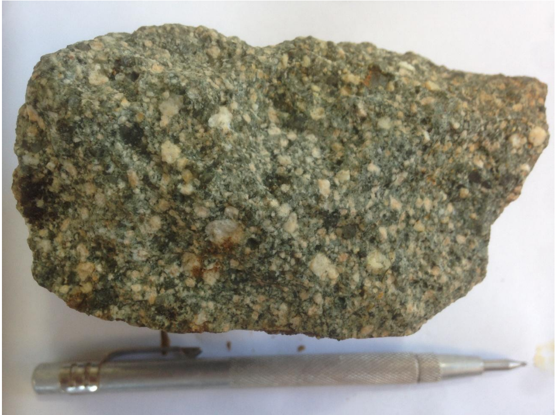
Figura 3.6. Pórfido Dacítico II cloritizado con hematita diseminada.
