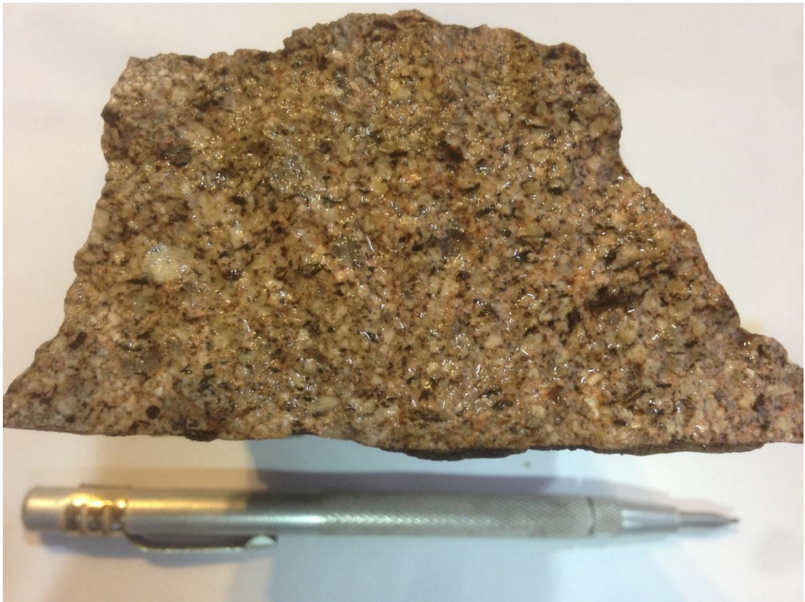
Figura 3.7. Pórfido Riolítico post-mineralización.
