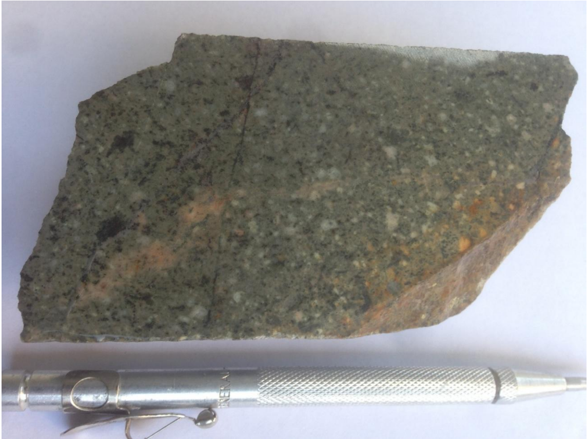
Figura 3.15. Pórfido Dacítico I silicificado, vetillas de cuarzo con magnetita y vetillas de cuarzo con halo de feldespato potásico.
