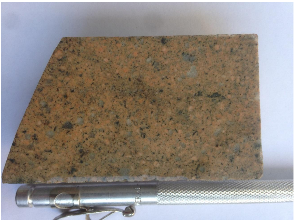
Figura 3.18. Pórfido Tonalítico con alteración potásica.
