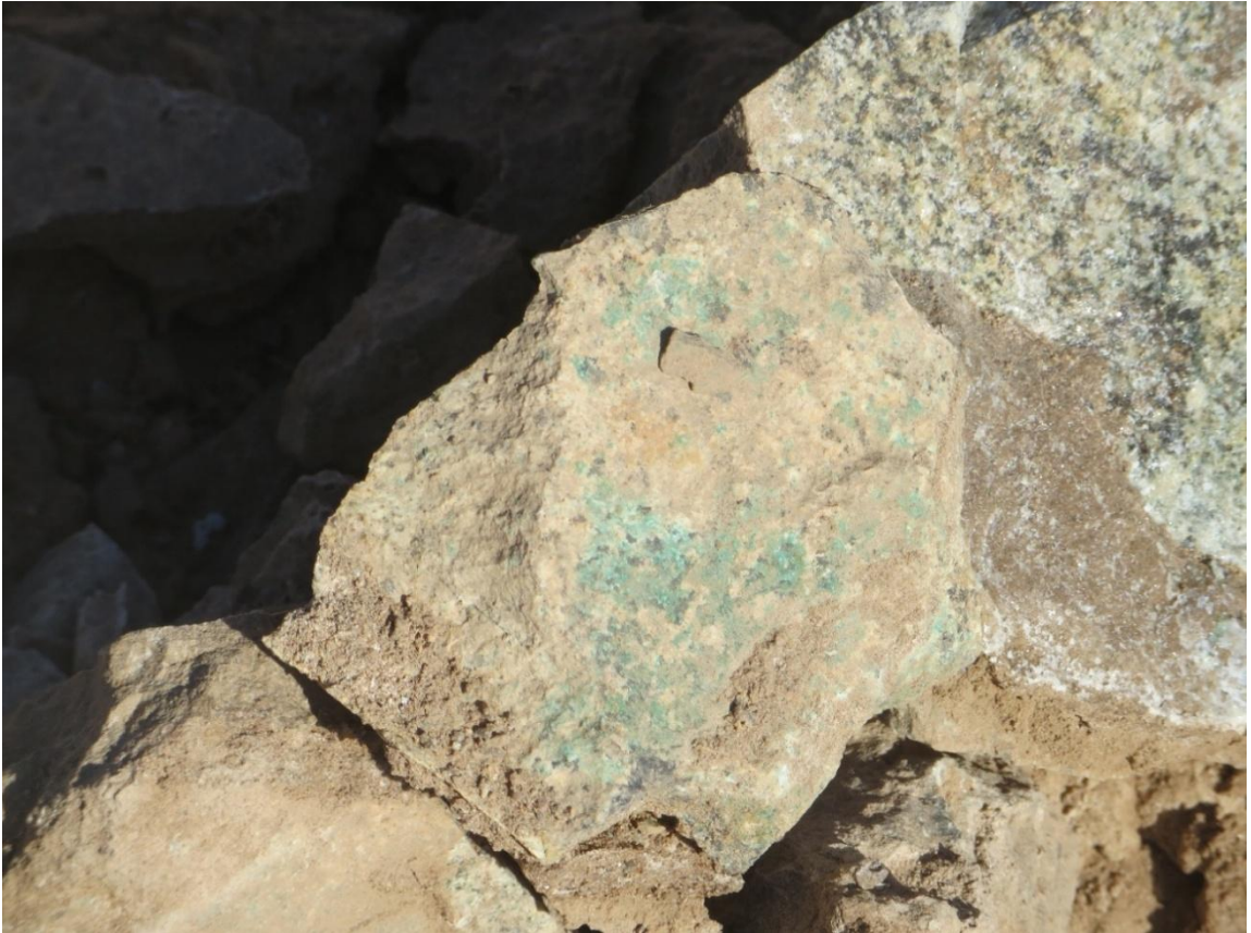
Figura 3.10. Pórfido Tonalítico con mineralización de oxidados de cobre (atacamita y crisocola) asociado con sales.
