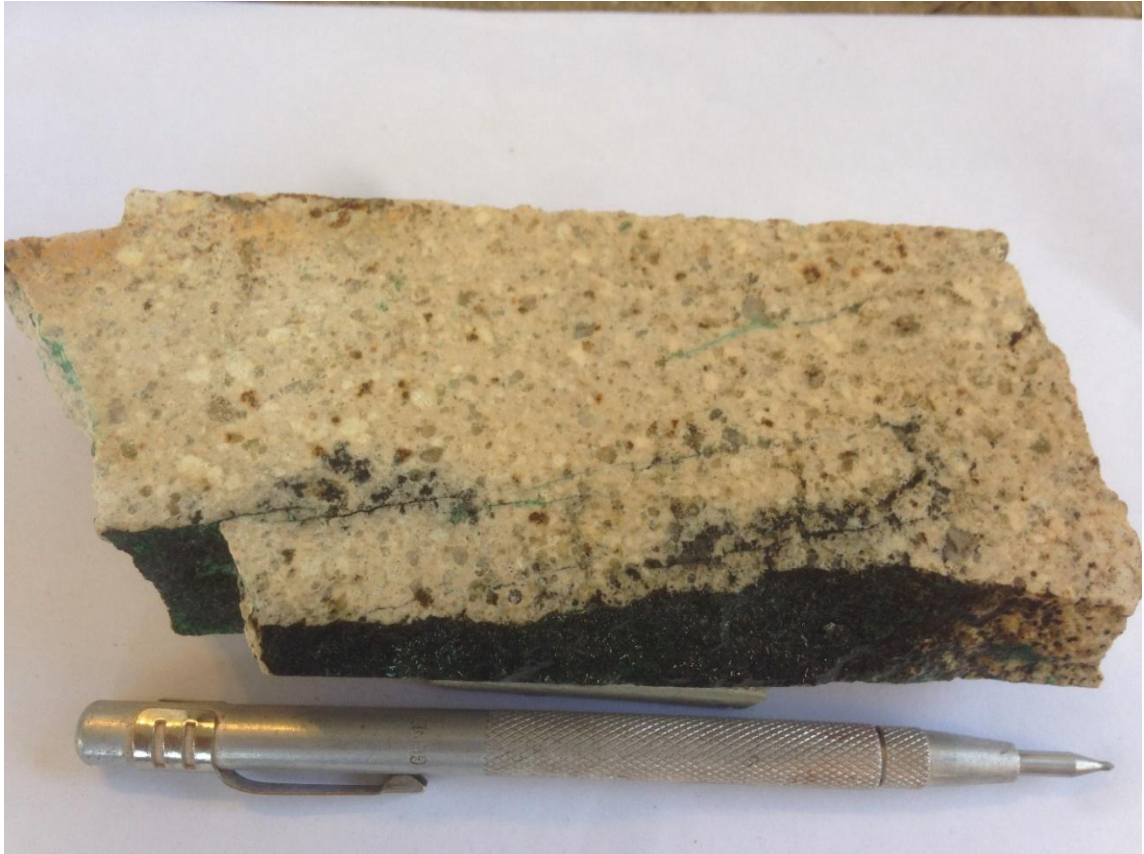
Figura 3.11. Pórfido Tonalítico con alteración cuarzo-sericita. Se observan vetillas de minerales opacos con atacamita.
