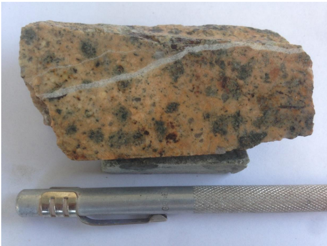
Figura 3.12. Pórfido Tonalítico con alteración potásica y alteración clorita-sericita sobreimpuesta. La corta vetillas de calcita y escasas vetillas de cuarzo-magnetita con sulfuros y halo de feldespato potásico. Trazas de calcopirita con pirita diseminada, asociada con hematita y oxidados de cobre.
