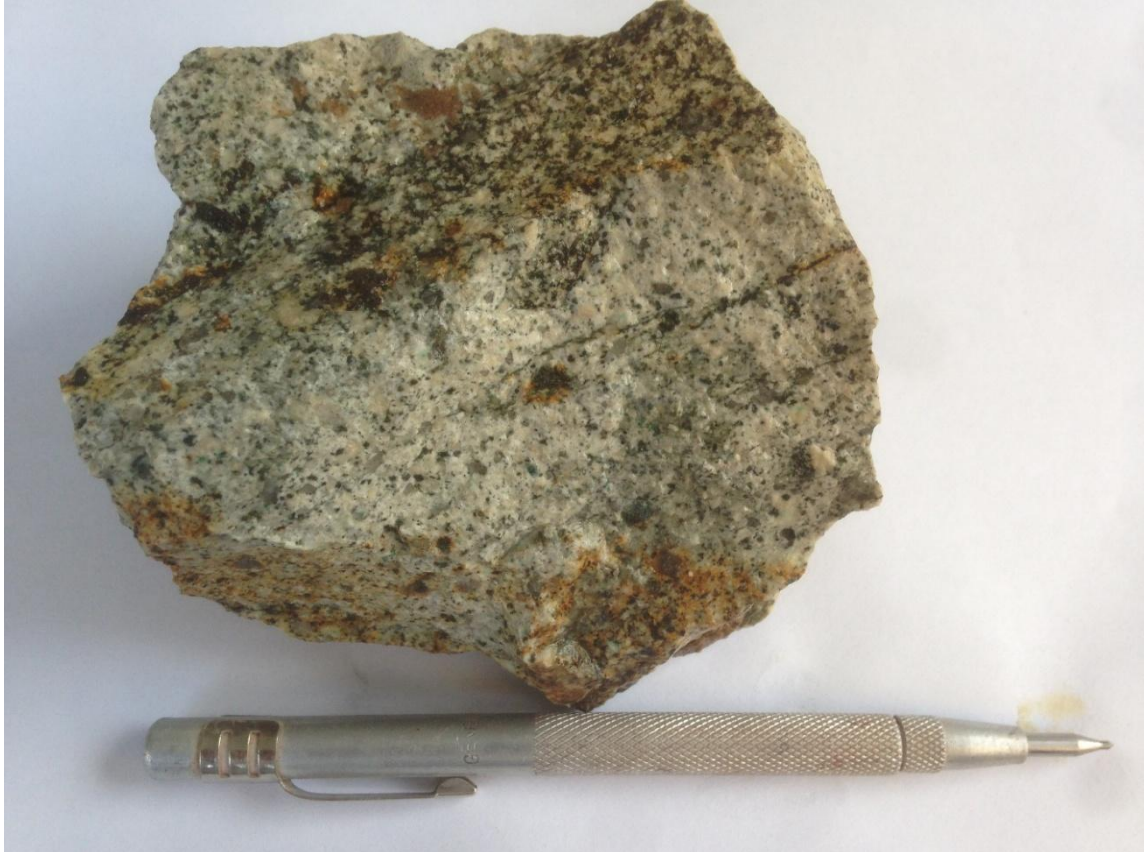
Figura 3.5. Pórfido Tonalítico con alteración de cuarzo-sericita. Se puede ver hematita diseminada y en vetillas.
