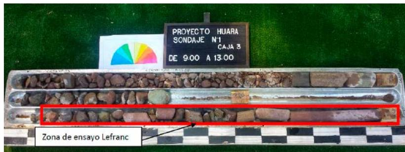
FIGURA 19. TRAMO DE 9-13 M DEL SONDAJE DONDE FUE REALIZADO EL ENSAYO DE LEFRANC.
