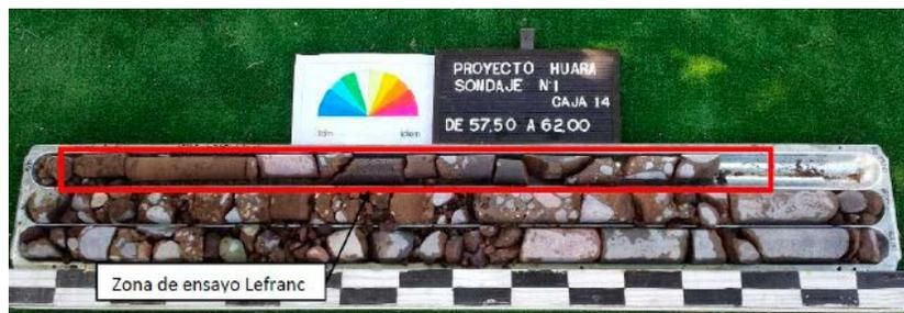
FIGURA 20. TRAMO DE 57.5-62 M DEL SONDAJE DONDE FUE REALIZADO EL ENSAYO DE LEFRANC.
