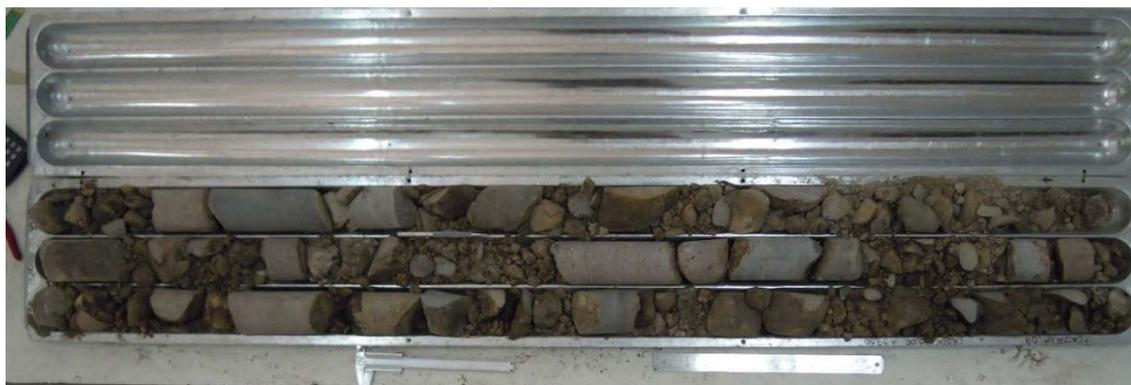
FIGURA 15. GRAVAS SUeltas CORRESPONDIENTES A LOS TRAMOS COMPRENDIDOS ENTRE 35 M Y 39.5 M DE PROFUNDIDAD.
