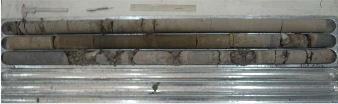
**FIGURA 17. TESTIGOS CORRESPONDIENTES A LOS TRAMOS COMPRENDIDOS ENTRE 98 M Y 102.5 M DE PROFUNDIDAD.**
