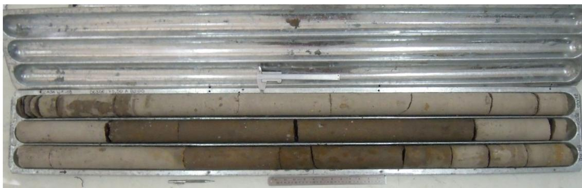
FIGURA 16. TESTIGOS DE ARENAS MEDIAS MODERADAMENTE CEMENTADAS CORRESPONDIENTES A LOS TRAMOS COMPRENDIDOS ENTRE 75.5 M Y 80 M DE PROFUNDIDAD.
