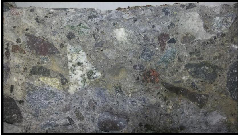
*Figura 17: Penetración de cloruros en probeta, visible después de rociarse con solución de nitrato de plata (blanco)*
