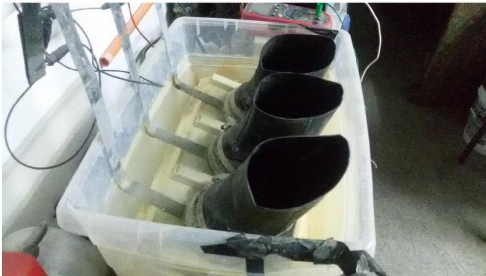
Figura 14: Montaje experimental ensayo Nordtest NT Build 492 (sin ánodos)
