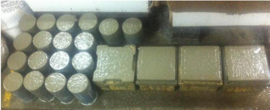
*Figura 6: Serie de probetas confeccionadas por colada*
