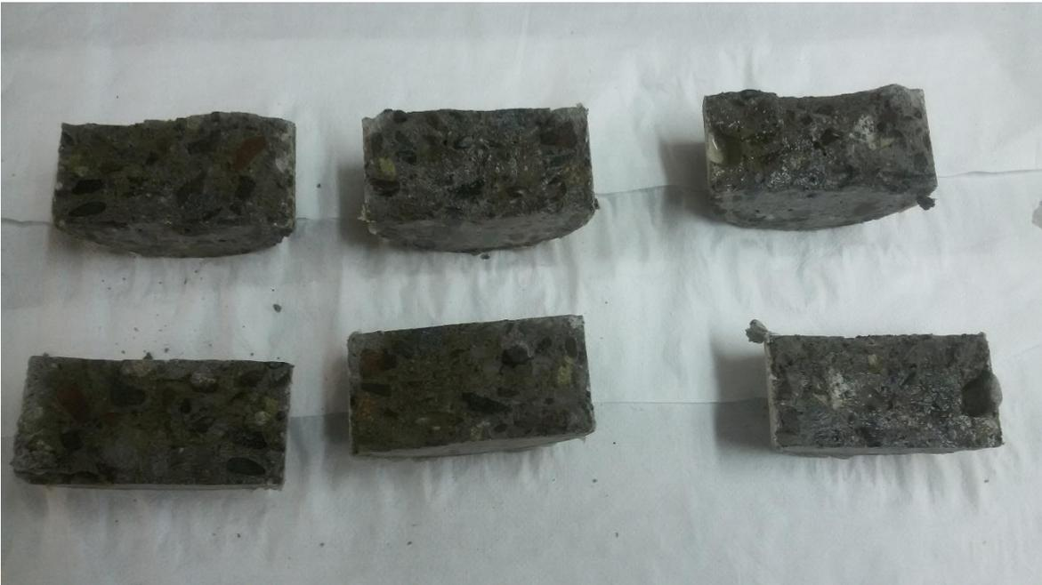
*Figura 16: Probetas hendidas, rociadas con solución de nitrato de plata. Se debe esperar de 20 a 30 minutos para que se tinte la zona donde penetra el cloruro*
