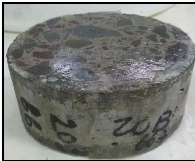
*Figura 9: Probeta cilíndrica, lista para ensayo*
