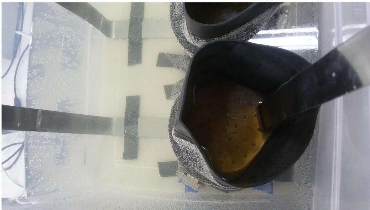
*Figura 24: Zona de reacción catódica, después del ensayo. Se observa acumulación de partículas sobre probeta y electrodo*
