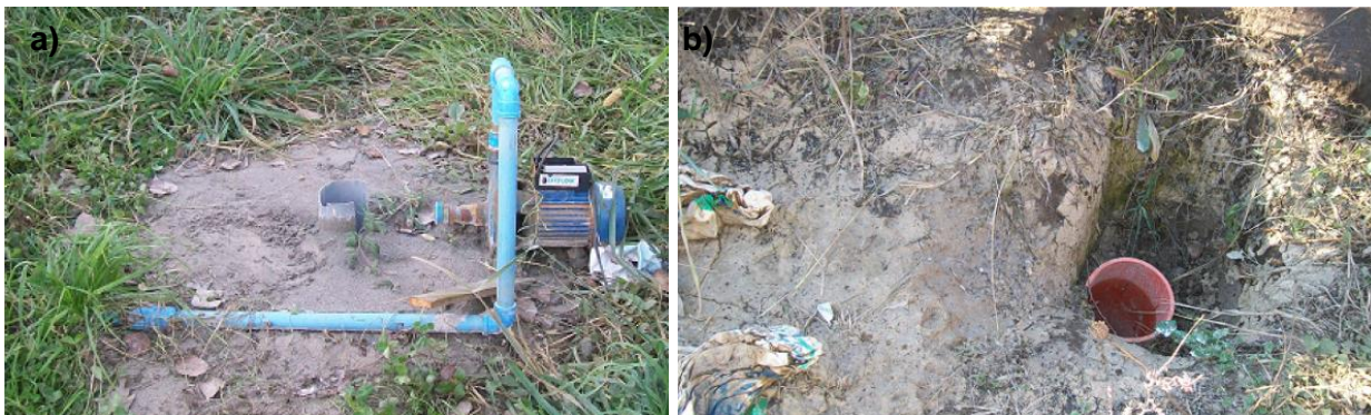
Fig. 5-29 Pozos por donde emergió material tipo ceniza (Andrade y otros, 2010).
