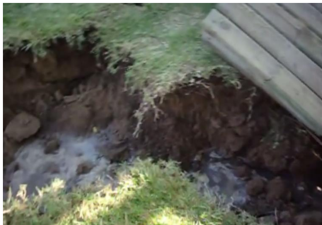
Fig. 4-68 Volcanes de suelo de cenizas volcánicas en Rapel (youtube/acevedovaldavenito).
