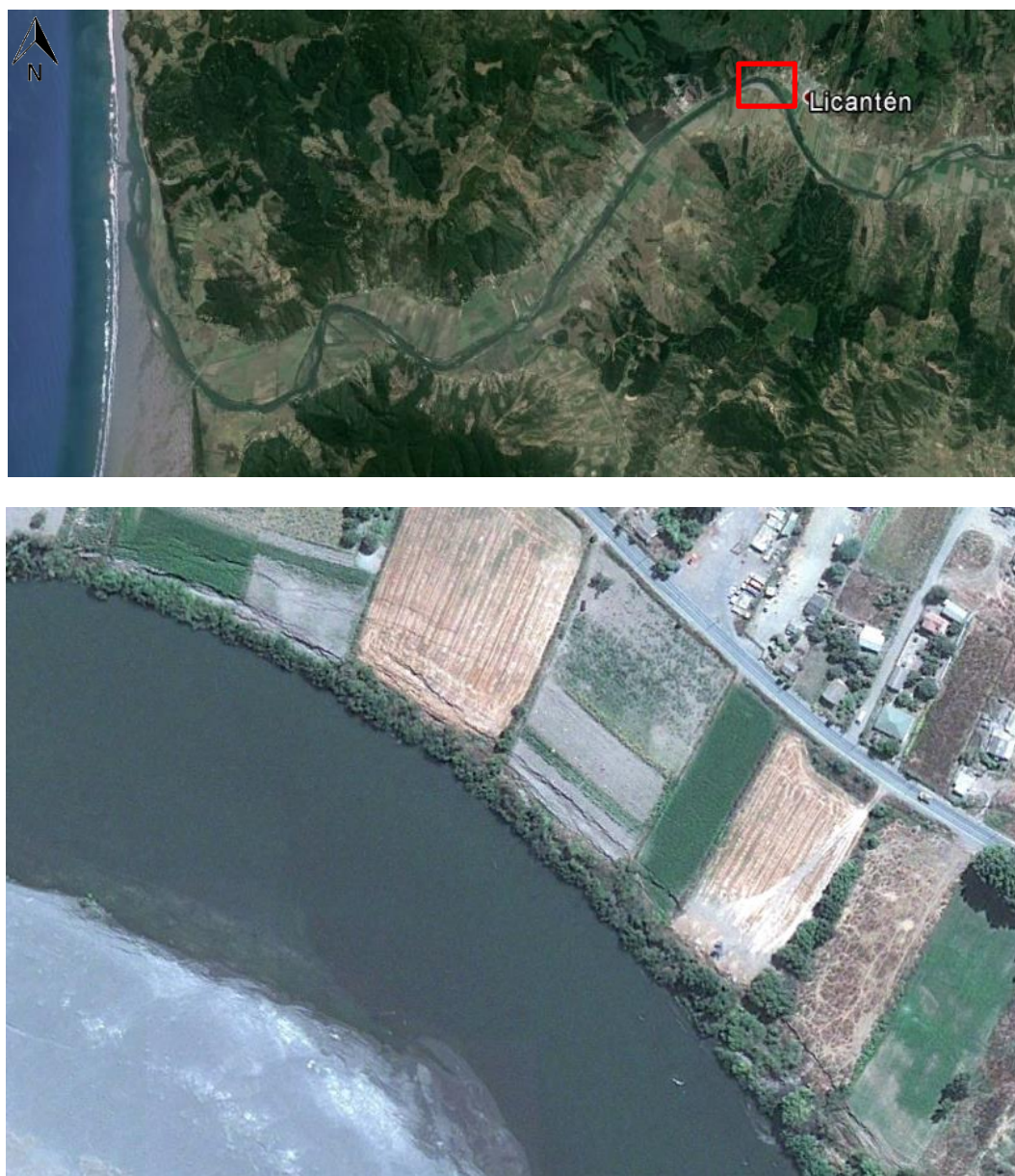
Fig. 4-9 Lateral Spreading en río Mataquito (Google Earth).
