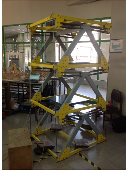
Figura 5.1: Estructura a controlar mediante el uso de un BTLCD
