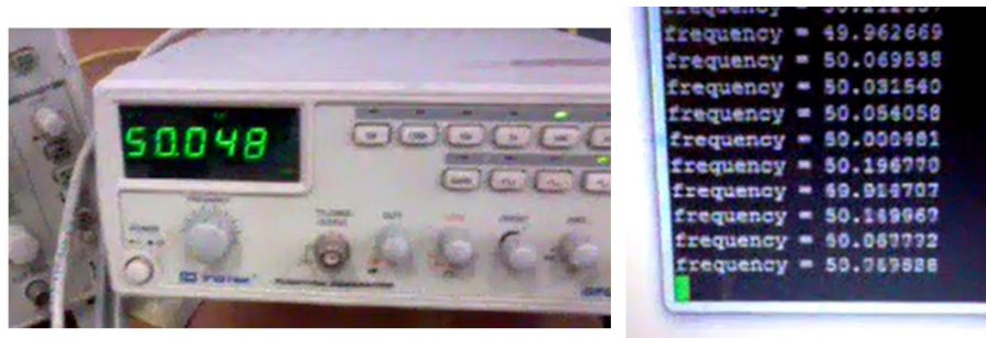
Figura 22: Datos de frecuencia del generador de funciones y del programa C++. Fuente: Propia
