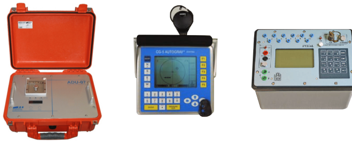
Figura 4.1: Equipos utilizados en las mediciones magnetotelúricas, gravimétricas y de resistividad eléctrica. Izquierda: ADU-07e; centro: CG-5; derecha: Syscal Pro
