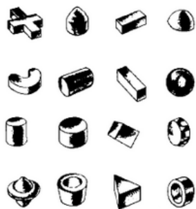
Imagen. Cabezas de controles indistinguibles por el tacto (relación forma-función)
