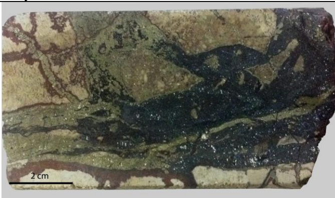
Fotografía 1. Aspecto general de la muestra. Se observan vetillas de pirita, con hematita y especularita que cortan la roca caja.
