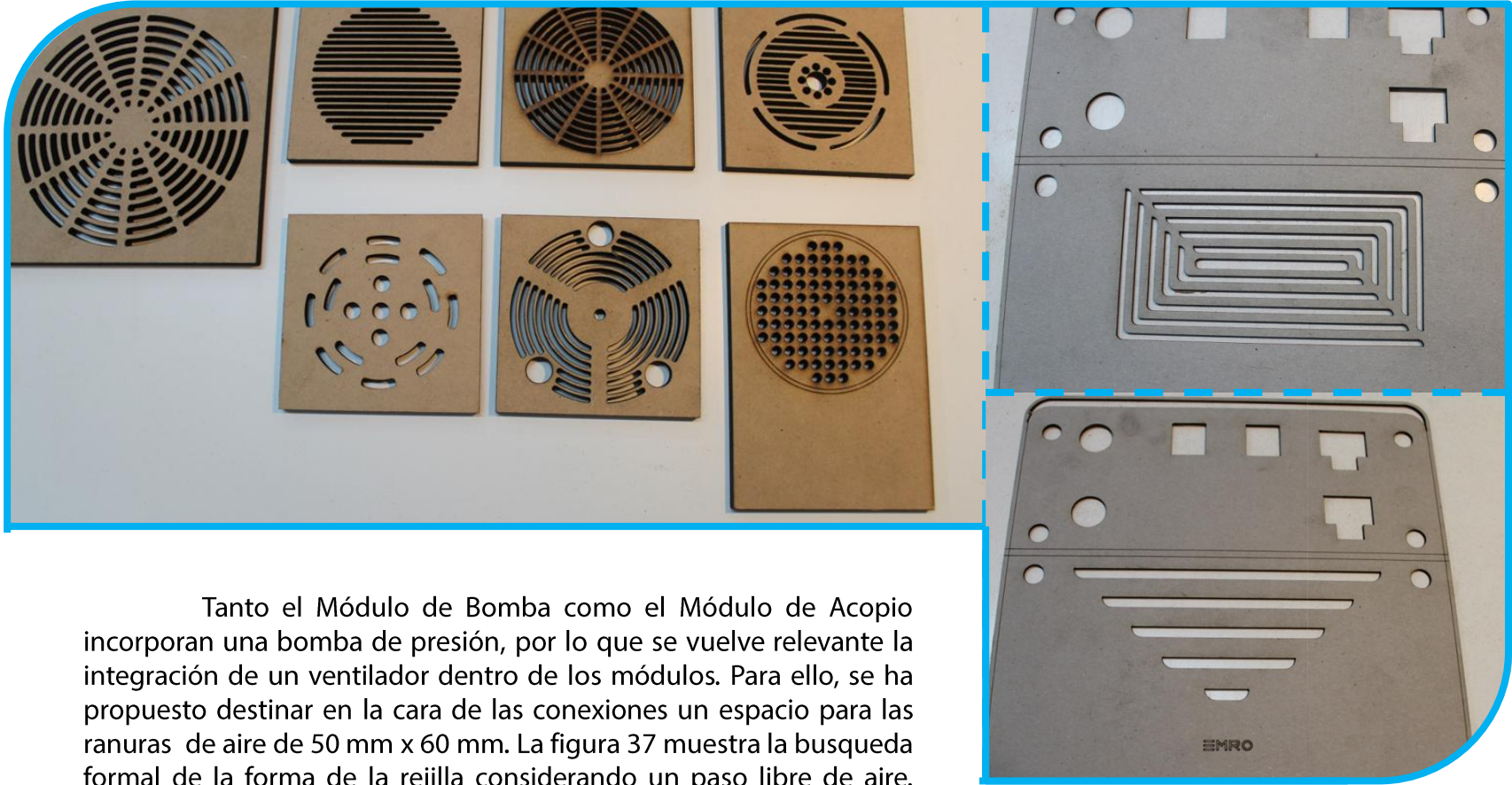
Fig. 37: desarrollo propuestas de rejillas de ventilación
