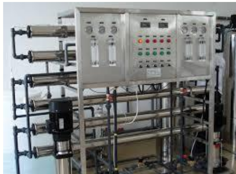
Fig. 11: Equipo de osmosis reversa, fuente Technotronicx
