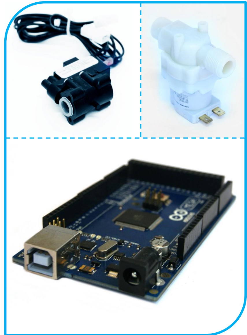
Fig. 23: Sensor de presión; Válvula solenoide; Captura propia Arduino Mega, fuente Arduino.cc
