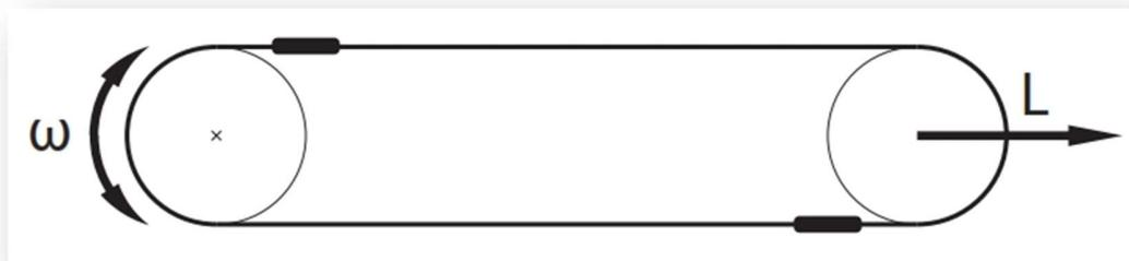
**Figura 5.1: Diseño conceptual de una fatigadora a flexión simple.**
