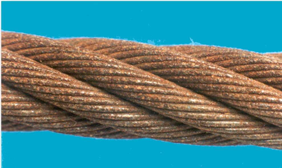
**Figura A-4: Detalle de corrosión externa**
