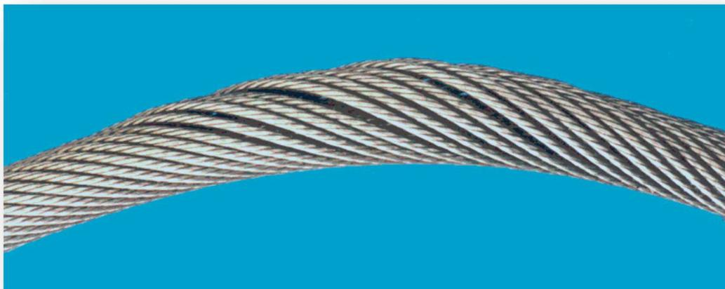
**Figura A-8: Deformación tipo canasto**
