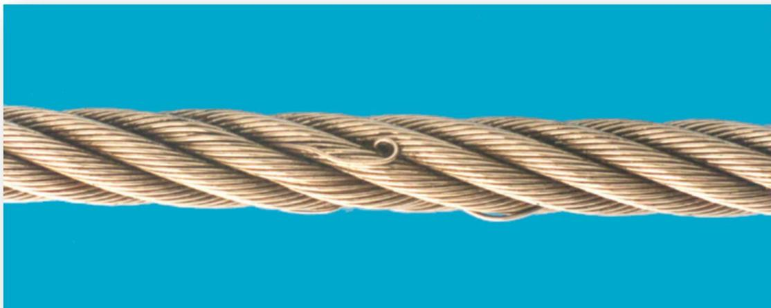
**Figura A-11: Protrusión de un alambre**
