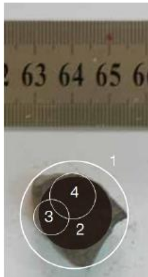
Figura 8-1: Ejemplo de cálculo de Factor de forma según Cho et al. (2006).
