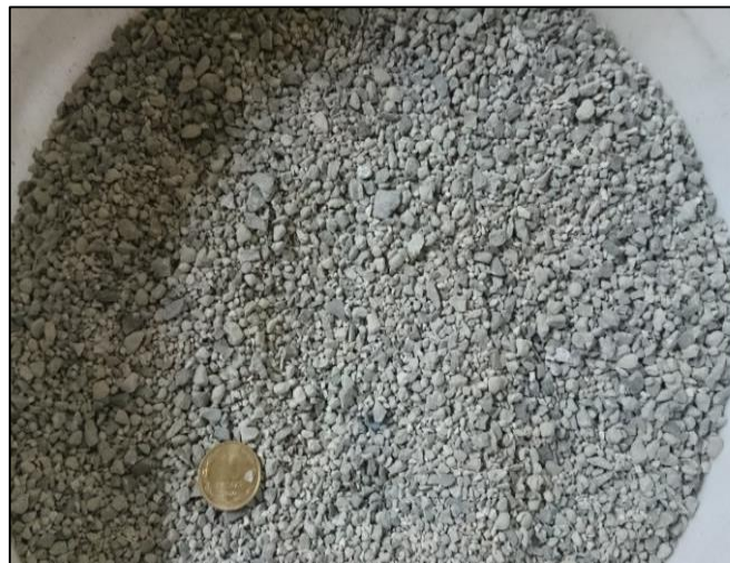
Figura 3-9: Muestra de la distribución de tamaños del mineral a escala de laboratorio.
