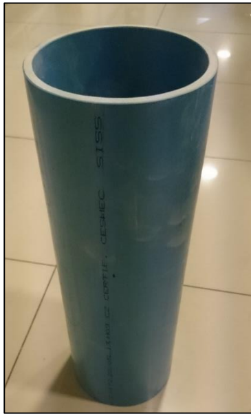
Figura 8-4: Cilindro utilizado para la estimación del ángulo de reposo del mineral.
