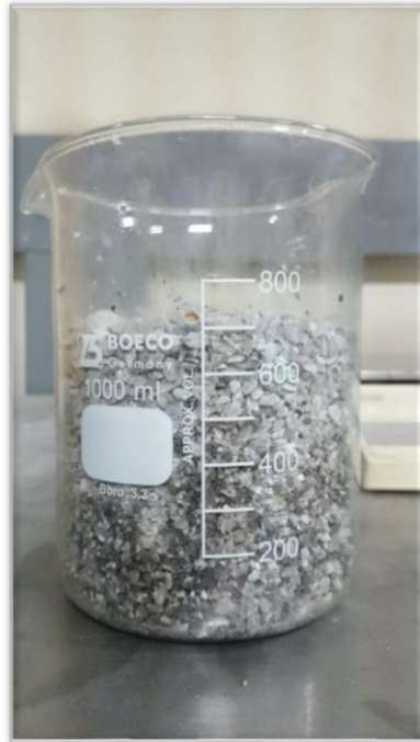
Figura 8-3: Volumen aparente de 1 kg de muestra.
