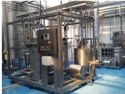
Ilustración XLIII Pasteurizador de Leche 69
