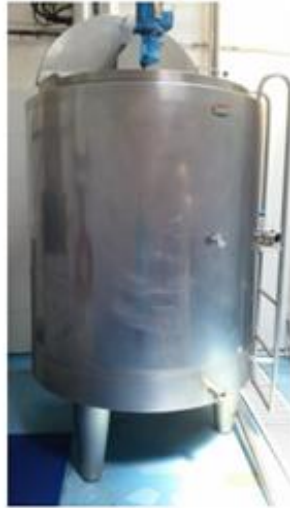
Ilustración LIII Tanque Inoculador de Yogurt 82
