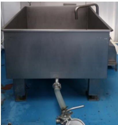
Ilustración XXVIII Cuba de filtración de la leche - Lactjubones 47
