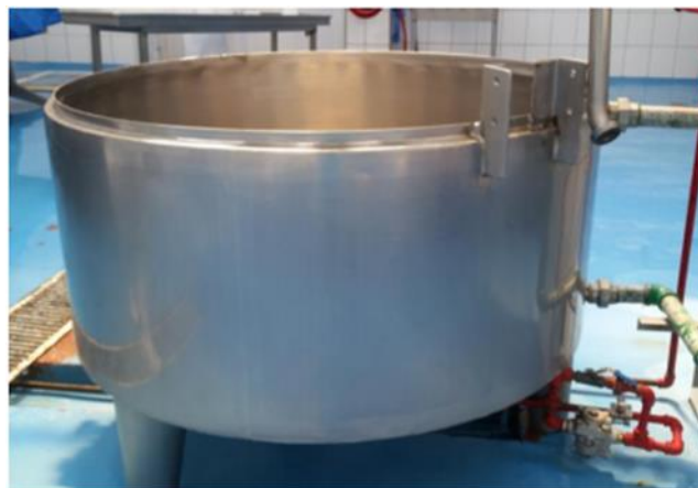
Ilustración XLIX Criba receptora de leche 76
