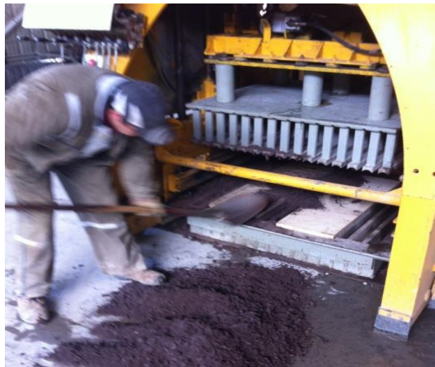
Figura 5.19: Carga manual de dos matrices de la ladrillera.
