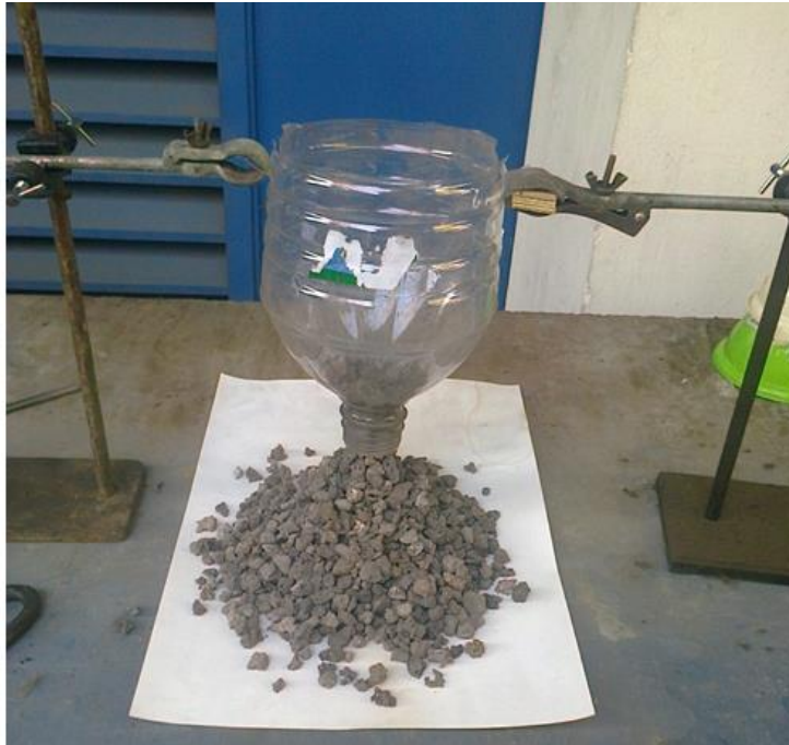
Figura 5.2: Montaje de granulometría modificado para particulado grande.
