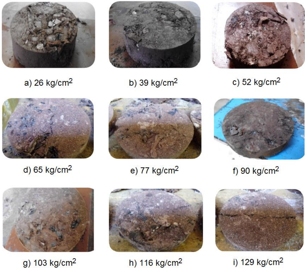
Figura 5.7: Briquetas cilíndricas muestras O5D5 compactadas a distinta presión.
