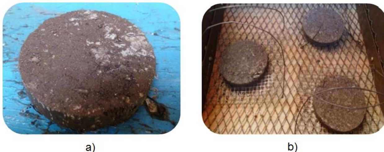
Figura 5.13: Muestras de ensayo de pre- y post-secado con PBat seca; a) briqueta compactada, b) briquetas luego de 0,75 h de secado.
