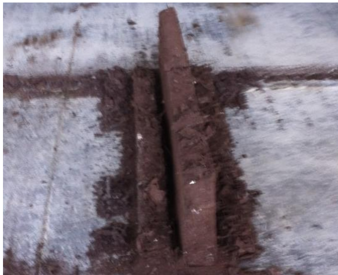
Figura 5.22: Bloque de mezcla con 5% de silicato de sodio y 13% de humedad de la pasta correspondiente a la prueba 6.
