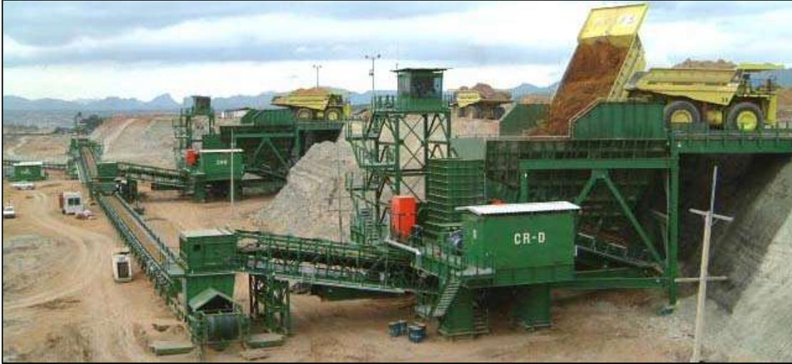
Figura 8: Chancador Semi-fijo, (Cooper A., Turnbull D. (2008))
