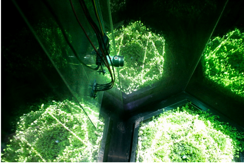
Fig. 45. Vista interior alta; se aprecian los sensores de CO 2 y temperatura.
