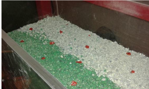
Figura 3- 4: Inserción de líneas de flujo y marcadores en el llenado del modelo físico.
