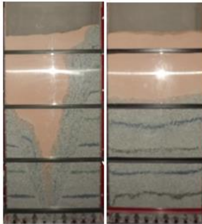
Figura 2- 9: Comparación entre tiraje Aislado (Derecha) y Tiraje Parejo (Izquierda) al 60% de extracción. (Irribarra, 2014).
