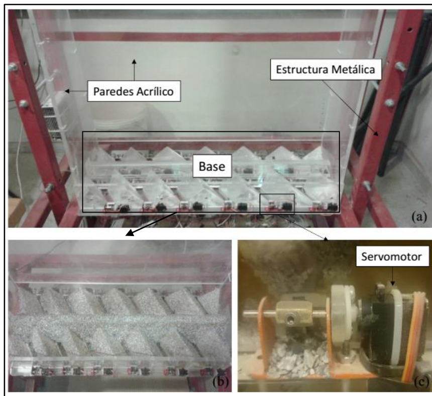
Figura 3- 3: Equipo experimental, (a) Módulo de acrílico montado sobre estructura metálica, (b) Base de la maqueta, (c) Sistema de Extracción.
