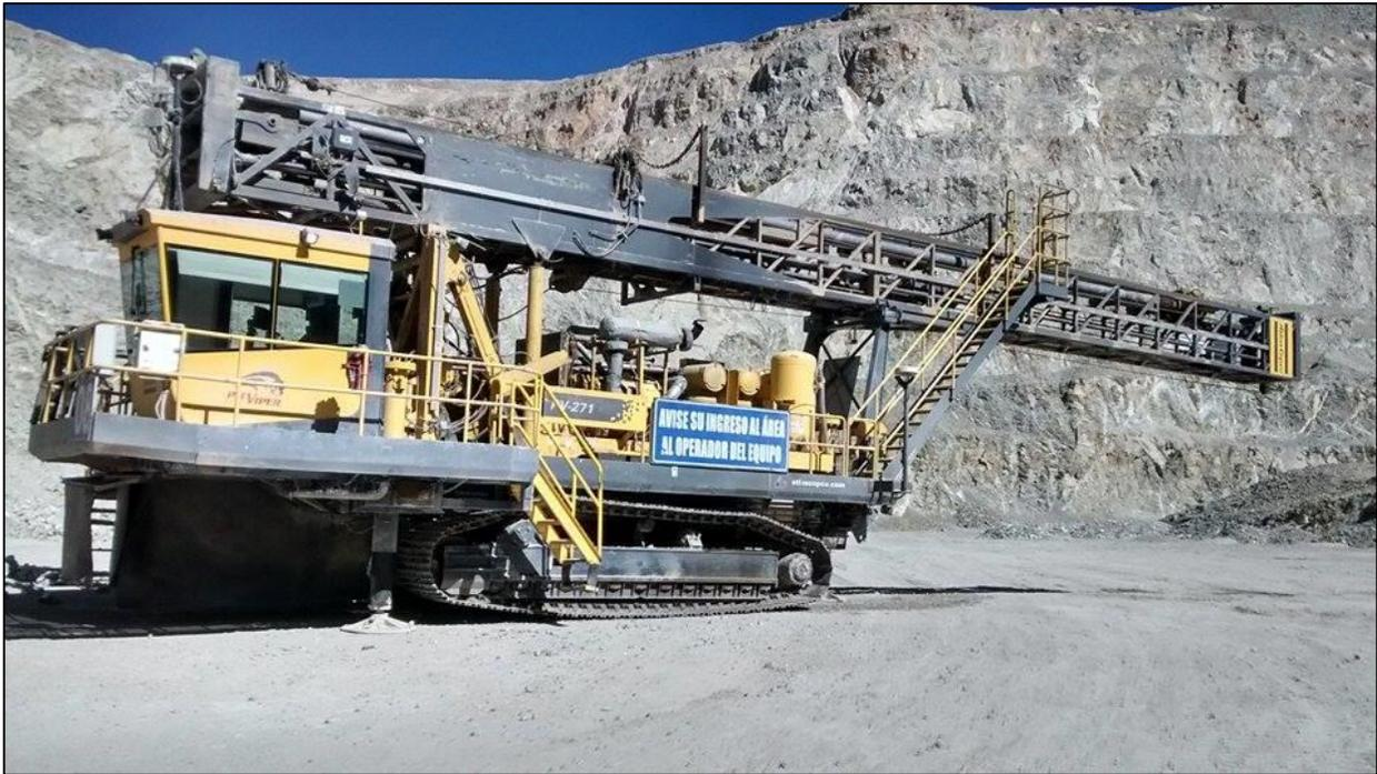
Figura 19. Equipo de perforación Pit Viper 271.
