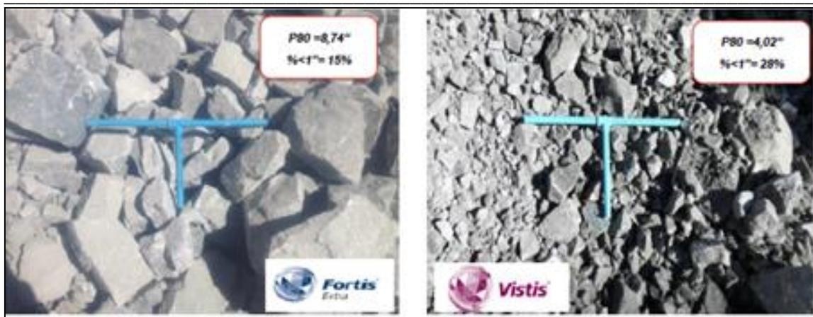
Figura 88. Comparación granulometría con escalímetro.
