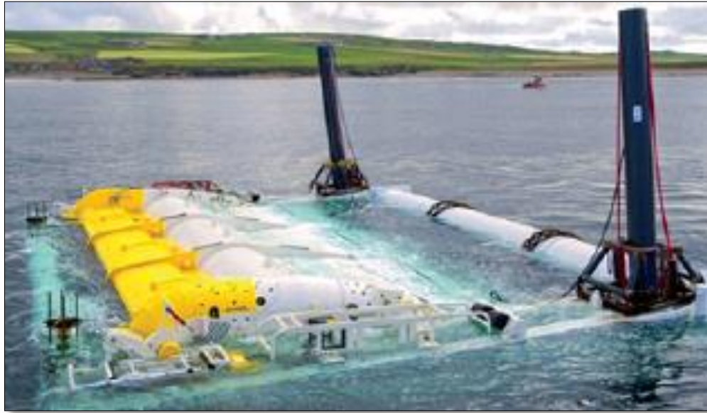
Figura 2.11: Oyster® 800 desarrollado y probado en UK. Potencia nominal 800kW [7]
