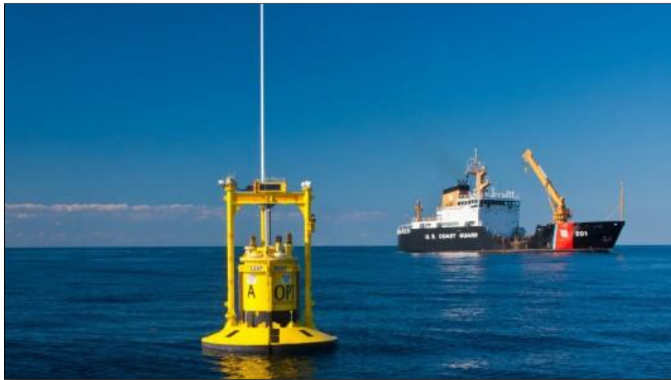
Figura 2.10: Powerbuoy PB150 desarrollado en USA y probado en EMEC [UK]. Potencia nominal 150 kW. [7]
