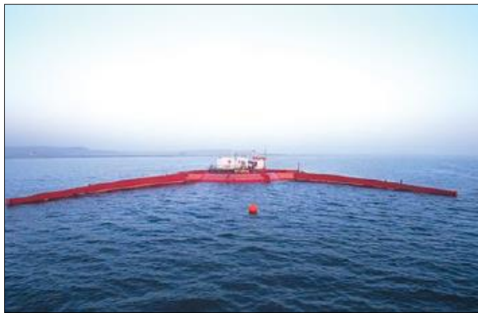
Figura 2.8: Wave Dragon desarrollado y probado en Dinamarca. Potencia nominal 11MW [7]
