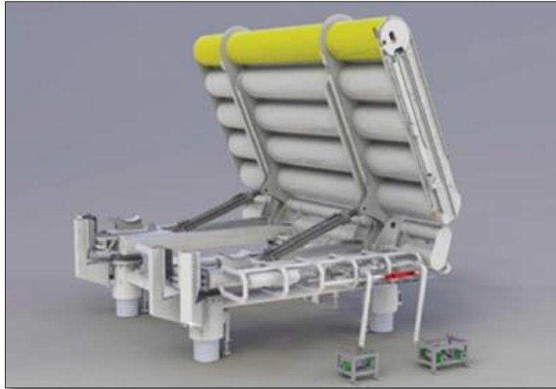
Figura 2.12: “Oyster 1” instalado en las islas Orkney en Agosto del 2009 [8]
