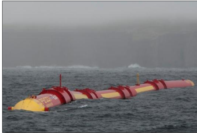
Figura 2.7: Pelamis P2 desarrollado y probado en UK. Potencia nominal 0,75MW [7]
