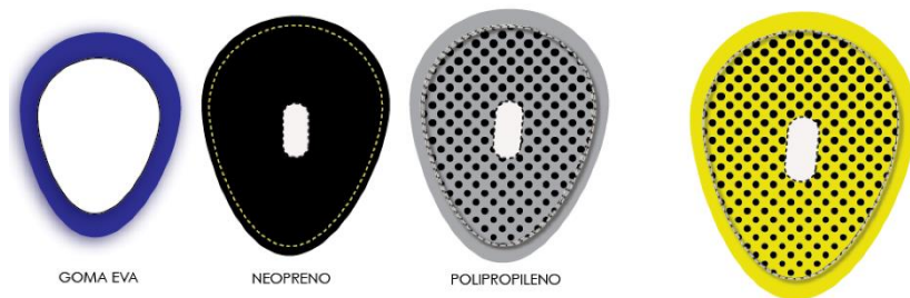
Ilustración 25 Composición prototipo final
