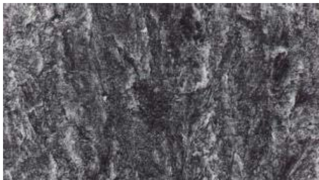
Figura N° 6: Patrón de grabado ácido del esmalte Tipo III Fotografía al Microscopio Electrónico de Barrido. Patrón de grabado de esmalte tipo III (44) .
