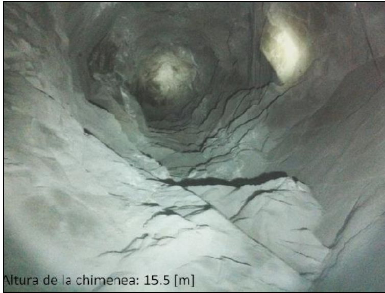
Ilustración 105. Fotografía resultado tronadura chimenea piloto, prueba C7 UCL.
