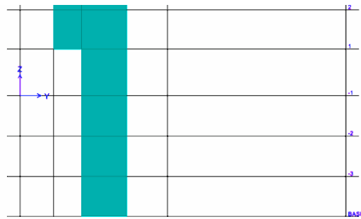
Figura 5.3. Elevación de base de muro 10-“Flag”, mostrando su disminución de largo entre pisos 1 y 2.
