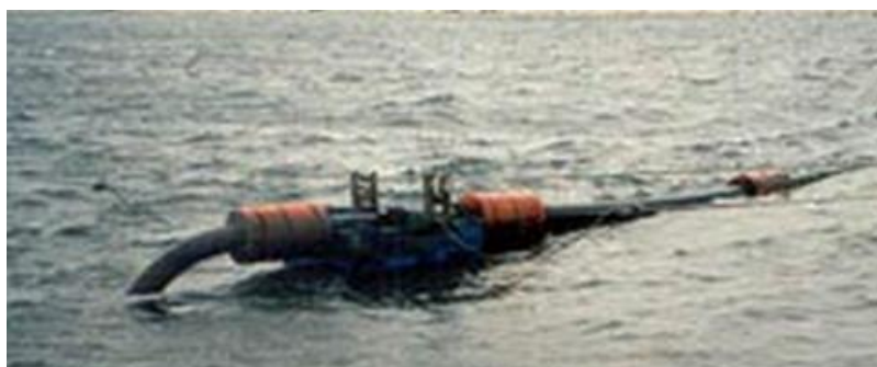
Figura 2.9. Método de deposición sub-acuática (Tailings, 2014).
