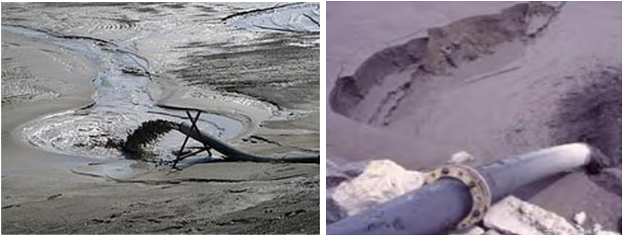
Figura 2.7. Método de descarga sub-aérea (DME, 1999).
