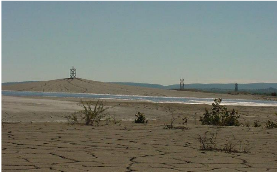
Figura 2.15. Depósitos de relave en pasta (Ramírez, 2007).
