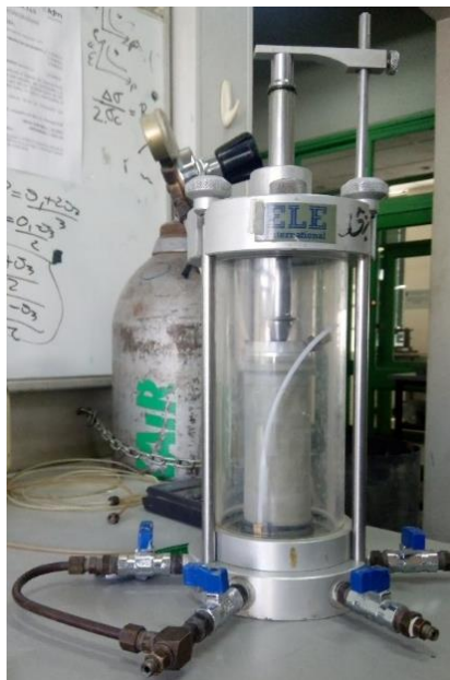
Figura 4.3. Celda triaxial utilizada para probetas de 5 x 10 cm.
