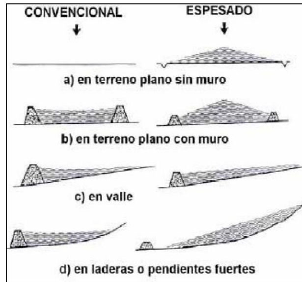
Figura 2.14. Diferencias entre Depósitos Convencionales y Depósitos de Relaves Espesados (Valdenito, 2008).
