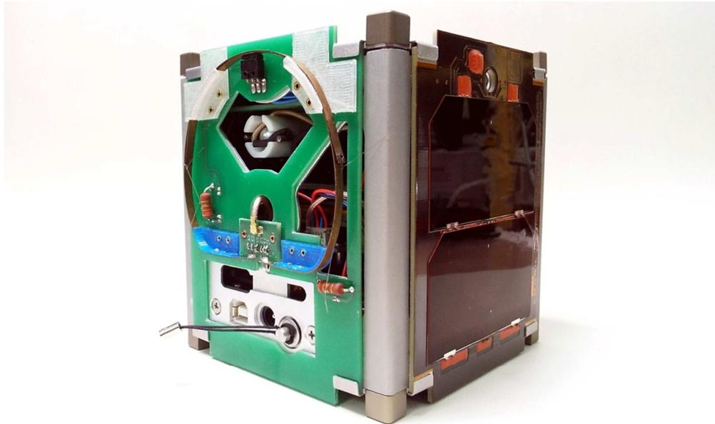
**Figura 2.** Estructura propuesta para el satélite SUCHAI la cual incluye una cara construida por fabricación digital.
