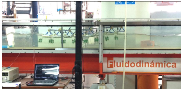
Figura 4.7 Imagen de prueba de sistema con una configuración de bloqueo 4 a 14V, lo que equivale a una condición de oleaje de 0,8911 [Hz], una altura de ola de 45 [mm] y una longitud de ola de 1604 [mm]. Fuente: Elaboración propia.
