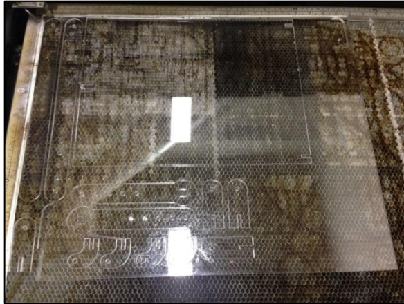
Figura 3.12 Corte de plancha de acrílico para construir el generador de olas. Fuente: Elaboración propia.
