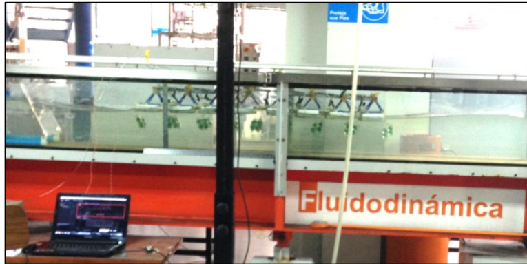
Figura 4.6 Imagen de prueba de sistema con una configuración de bloqueo 4 a 13V, lo que equivale a una condición de oleaje de 0,8911 [Hz], una altura de ola de 32 [mm] y una longitud de ola de 1604 [mm]. Fuente: Elaboración propia.
