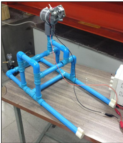
Figura 3.17 Conjunto motor limpiaparabrisas, estructura estática del generador de olas y orejas para el pasador de aleta. Fuente: Elaboración propia.
