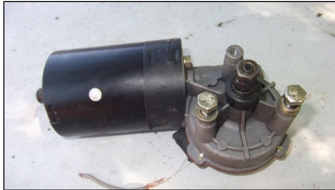
Figura 3.16 Motor de limpiaparabrisas utilizado como motor de generados de olas. Fuente: Elaboración propia.
