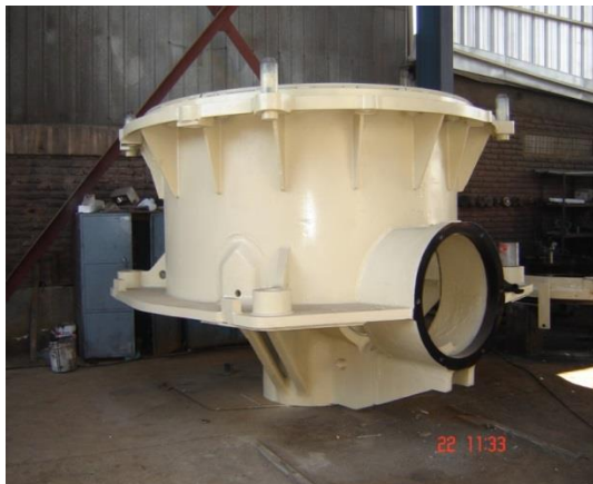
Main frame chancador Symons de 7' reacondicionado:
