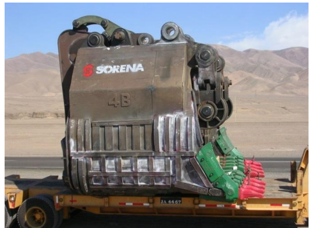
Balde Pala "Bucyrus" 495-B de 56 yd.cu. Reacondicionado
