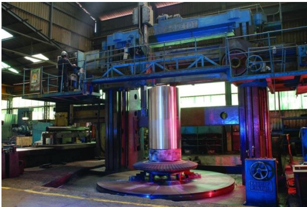
Main frame chancador Symons de 7' reacondicionado:
