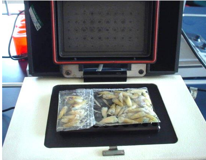
Figura 7: Grupo B y Grupo Control Positivo dentro de la termocicladora antes del inicio de los ciclos.
