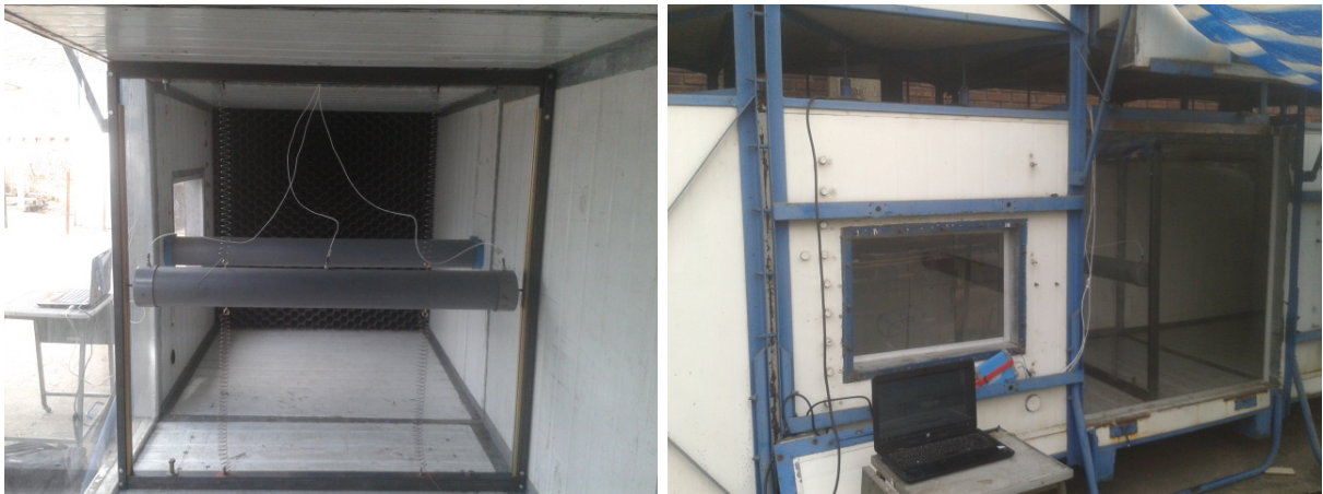
(a) Ubicación de los acelerómetros en el montaje. (b) Adquisición computacional de los datos experimentales.
