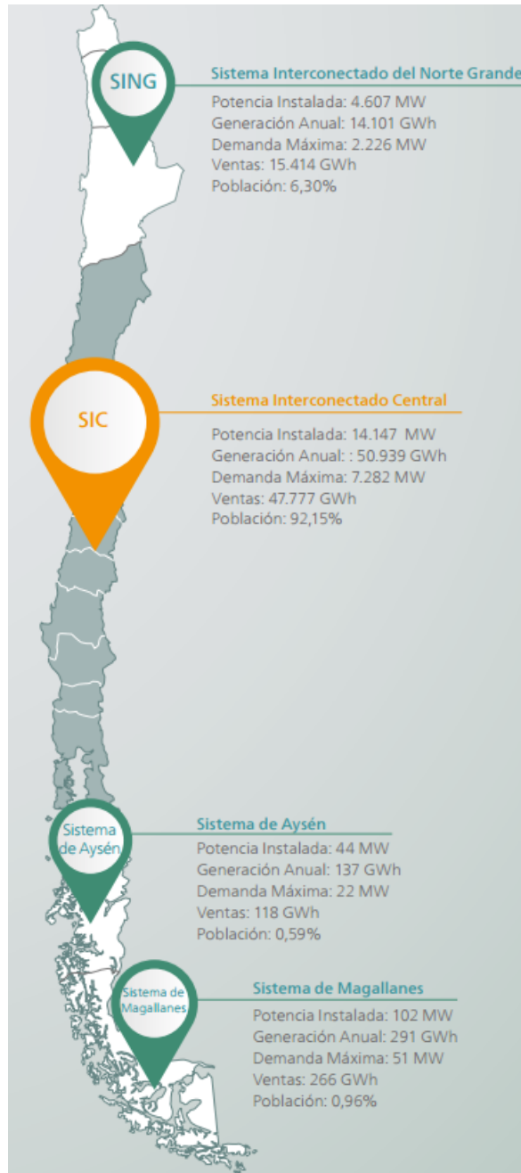
Figura 2.13: Distribución de sistemas eléctricos en Chile [35].
