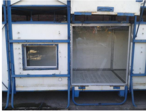
Figura 4.2: Vista frontal de modificación de panel cerrado por acrílico.
