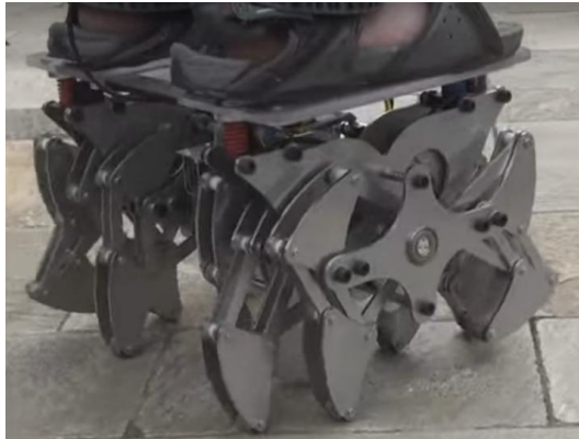
Figura 1-6 Vehículo con mecanismo de Theo Jansen, tracción con motores eléctricos 5 .
