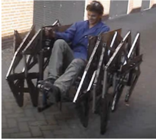
Figura 1-5 Vehículo con mecanismo de Theo Jansen, tracción híbrida 4 .
