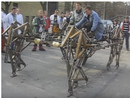
Figura 1-7 Vehículo con mecanismo de Theo Jansen, tracción con motores de combustión interna 6 .
