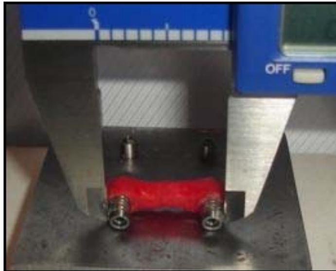
**Fig.15 Medición de la Variación Dimensional post ferulización:** muestras colocadas horizontalmente sobre la plataforma, medición sub-milimétrica con caliper digital a la altura de la 2ª línea estandarizada de los transfers (ver Fig. 8)
