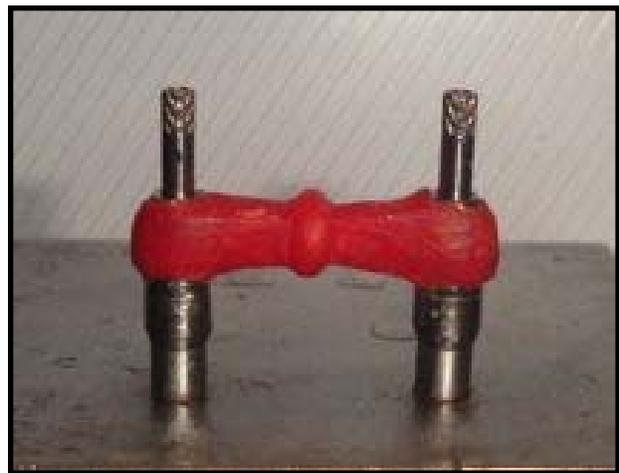
**Fig. 19 Bloque acrílico referulizado:** muestra posicionada en la plataforma y referulizada con resina acrílica en forma de anillo.
