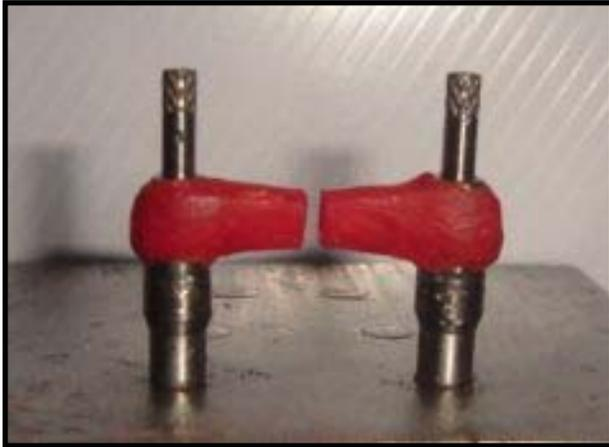
**Fig. 18 Corte de muestras:** muestra seccionada y posicionada sobre análogos en la plataforma, fijada con los tornillos. Separación de 1mm en el bloque ferulizador.
