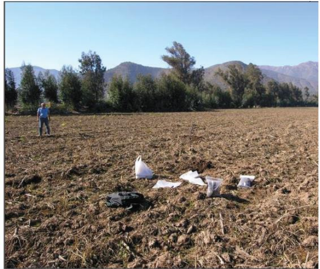
Figura 3.3. (a) Muestreo del perfil 0 a 5 cm. (b) Muestras tipo Compósito almacenadas en bolsas de polietileno.
