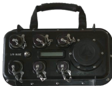
Figura 9_Anexo1. Equipo almacenador de información Reftek RT130.
