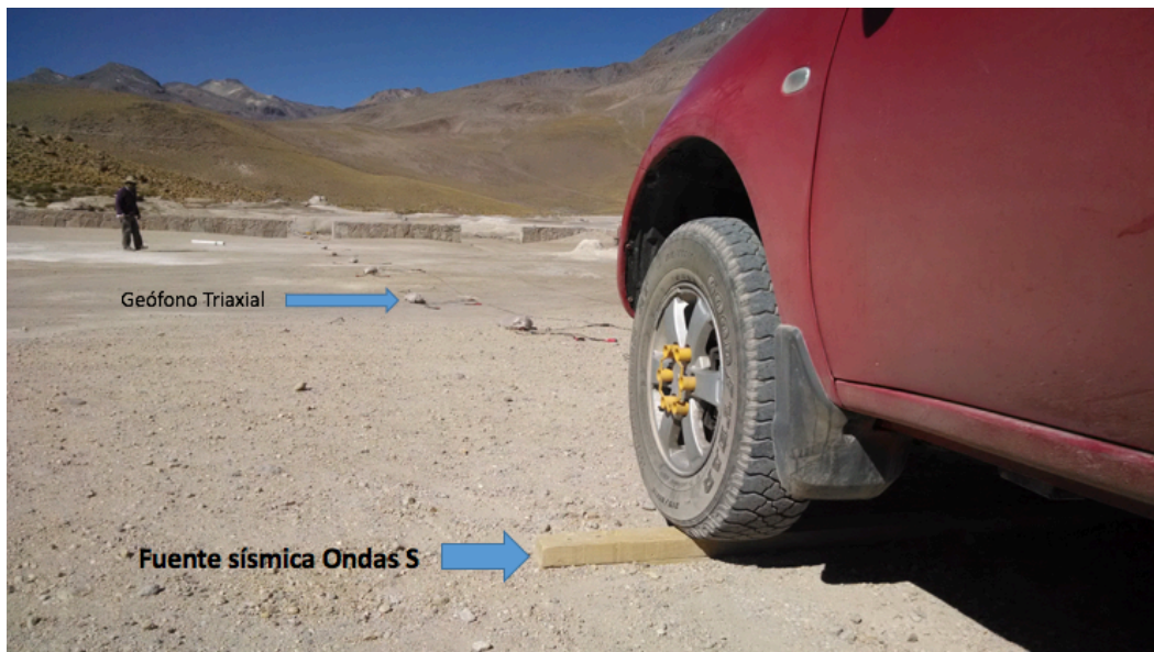
Figura 5.1 La imagen muestra la fuente sísmica empleada para la generación de ondas S. El borde lateral de la viga que indica la flecha inferior fue impactado con un martillo (golpes horizontales) para producir ondas de corte con una polaridad perpendicular a la dirección de la línea, la cual es registrada por la componente perpendicular de los geófonos a la línea.
