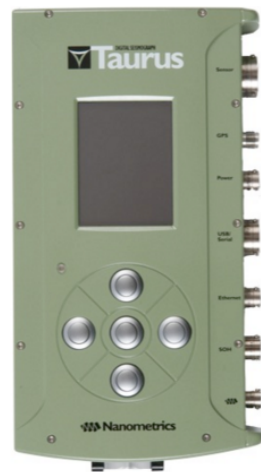
Figura 10_Anexo1. Digitalizador Sismo métrico Taurus
