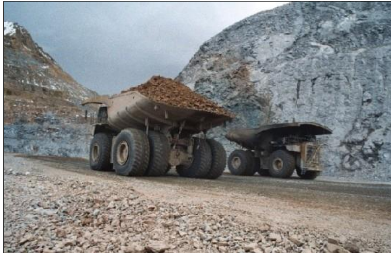
Ilustración 20. Carpeta de rodado con supresor bituminoso, minera en Los Pelambres.
