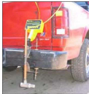
Ilustración 8. Montaje del equipo DustMate en camioneta
