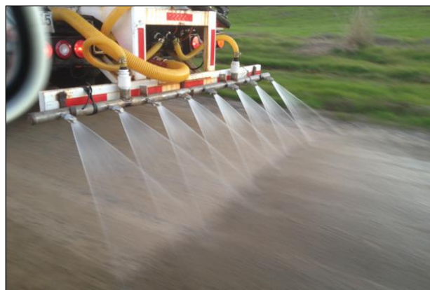
Ilustración 10. Barra con boquillas de dosificación del supresor
