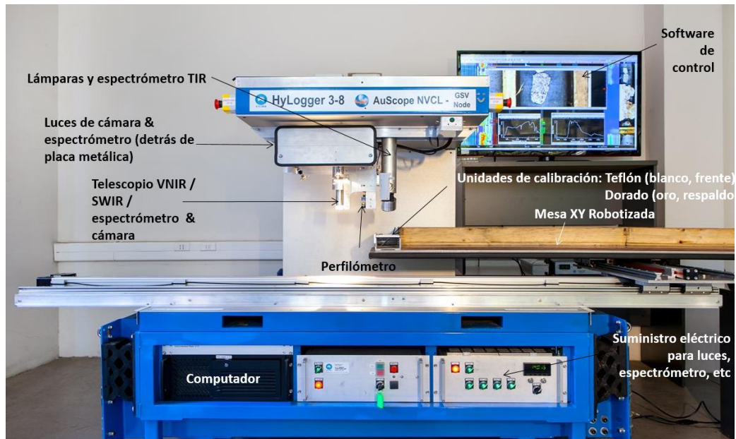
Figura 20. Componentes del Hylogger-3.
