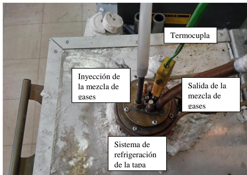
Figura 37. Principales componentes de la tapa del horno eléctrico de laboratorio.
