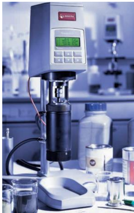
Figura 18. Equipo utilizado en el procedimiento experimental, Anton-Paar Rheolab QC.
