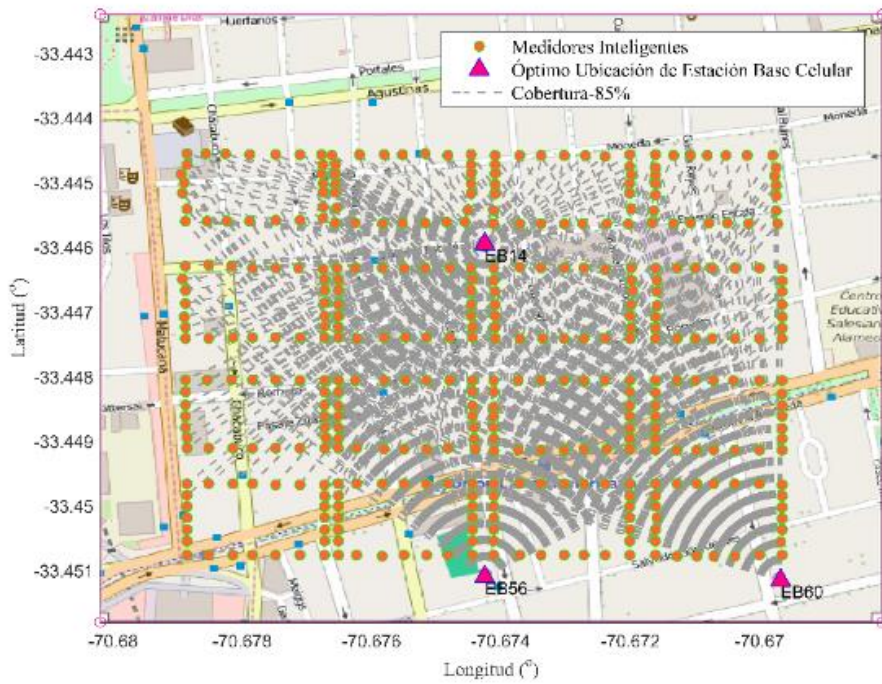
Figura Nro. 31 Ubicación Optimizada con 1 BS con Cobertura 70% vs Ubicación Optimizada con 3 BS con Cobertura 85% con base en modelo propuesto en [50].
