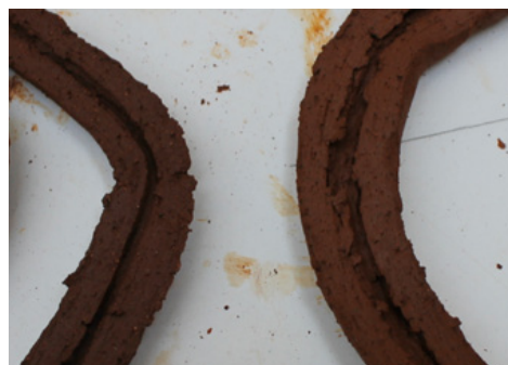
Imagen 162 Pared irregular del conducto del aza. Fuente: Elaboración propia
