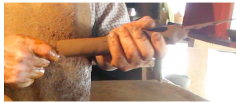
Imagen 154 Se atraviesa un alambre tenzado para ahuecar el "lulo". Fuente: Elaboración propia
