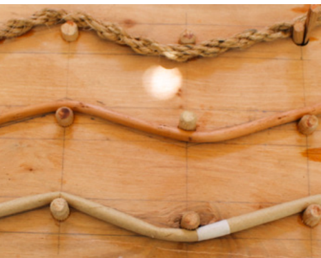
Imagen 165 Pequeña matriz para probar el curvado de los materiales. Fuente: Elaboración propia
