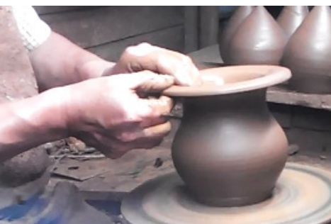
Imagen 150 Se comienza a realizar el conducto superior del jarro. Fuente: Elaboración propia
