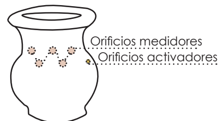
Figura 24 Una vez realizado el cuerpo se deben hacer los diferentes orificios. Fuente: Elaboración propia.
