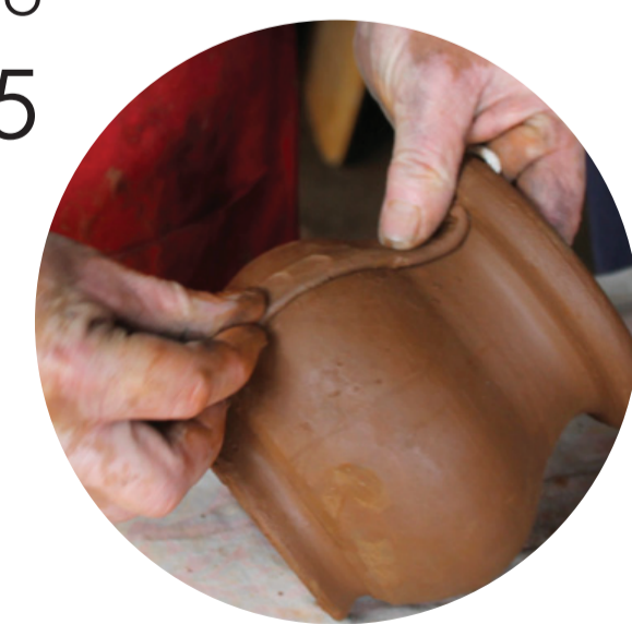
5 Cubrir el conducto con greda
