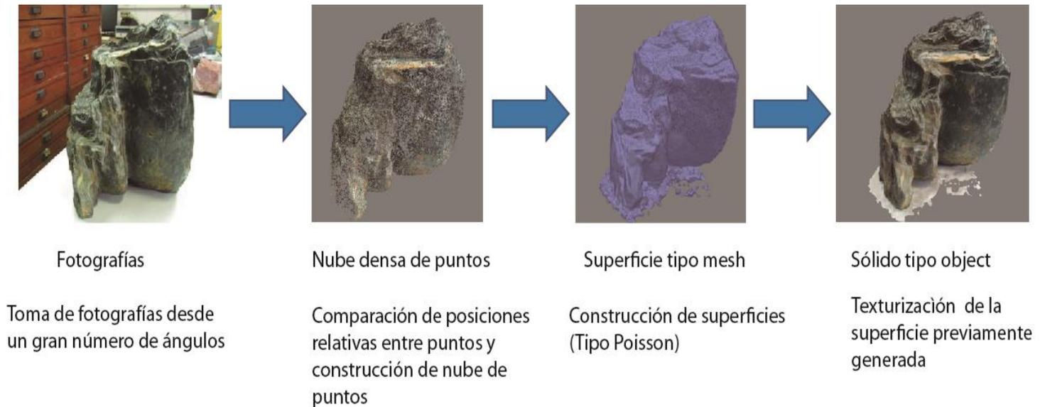
**Figura 14:** Esquema ilustrativo del proceso de reconstrucción tridimensional mediante la técnica de fotogrametría digital.
