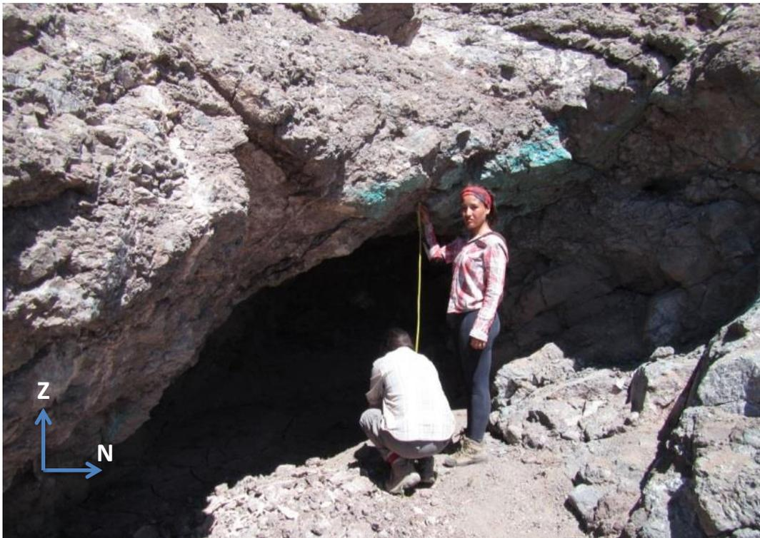
**Figura 36:** Fotografía de la toma de mediciones de distancias entre puntos de control usados en la georreferenciación, la orientación de la fotografía es N-S.
